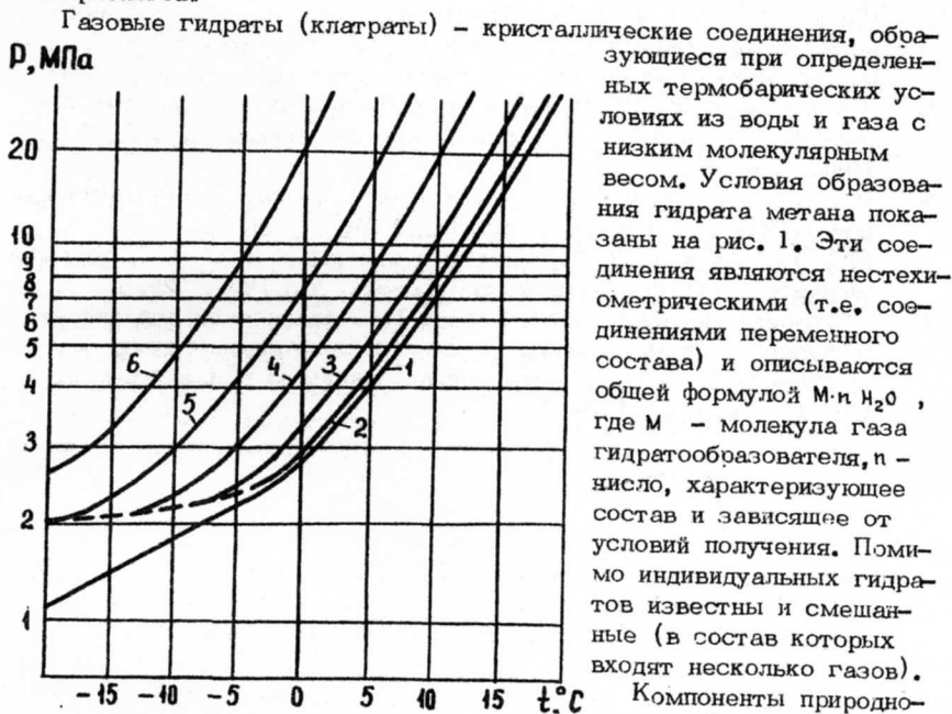
Рис. 1. Влияние засоленности поровых вод на равновесные условия гидратообразования метана: 1, 2, 3, 4, 5, 6, соответственно, весовое содержание в поровых водах, 0%, 5%, 10%, 15%, 20%, 25%
