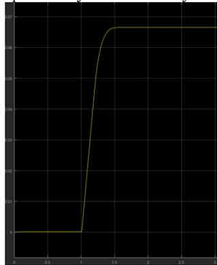
Рис.7. График переходного процесса выдвигания ГЦ.
