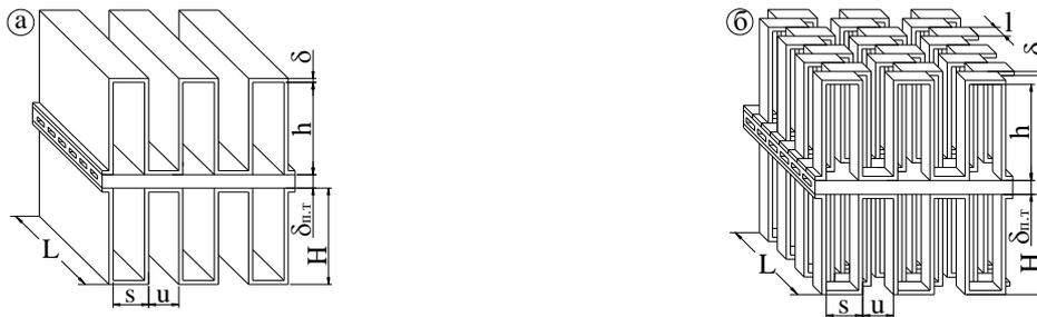
Рис. 2. Геометрические характеристики пластинчато-ребристых гладкоканальной — а и рассечённой — б теплообменных поверхностей [3]
