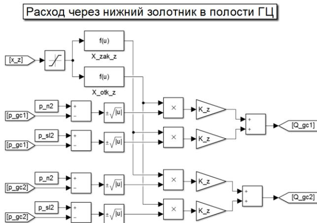
Рис.3. Структурная схема модели расходов через нижний золотник.
