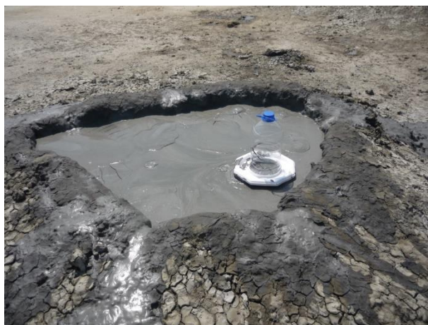
Рис. 3. Стационарная камера (ловушка) для накопления метана и определения скорости его потока, установленная в одном из кратеров вулкана Гнилая гора (Гефест)
