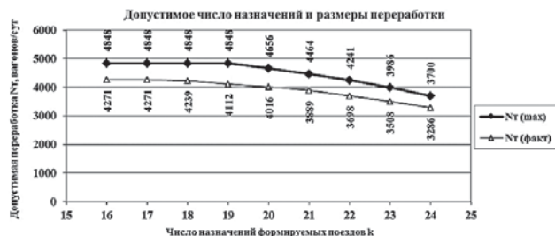
Рис. 4. График зависимости предельно допустимой переработки от количества формируемых назначений.
