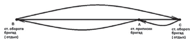
Рис. 6. Схема оборота бригады при наличии нескольких пунктов оборота на одном УРЛБ
