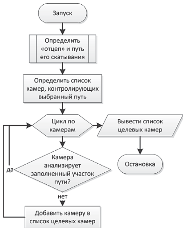
Рис. 3. Алгоритм выбора целевых камер
