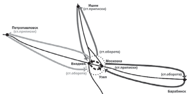
Рис. 3. Пример организации бригадного оборота с «узловой» станцией Входная – Московка
