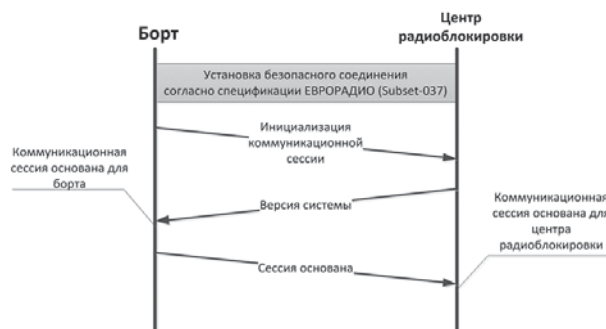
Рис. 3. Установление соединения между бортовой подсистемой и РБЦ
