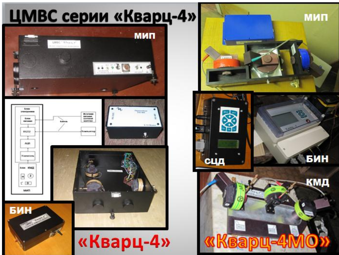
Рис.2. ЦМВС на основе КМД - «Кварц-4» (первая модель) и «Кварц-4МО» для МО и редко обслуживаемых ПН.
