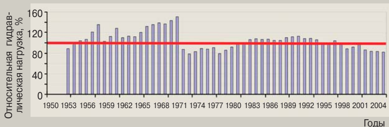
Рис. 3. Относительная гидравлическая нагрузка на КОС (отношение реальной нагрузки к проектной мощности сооружений)
