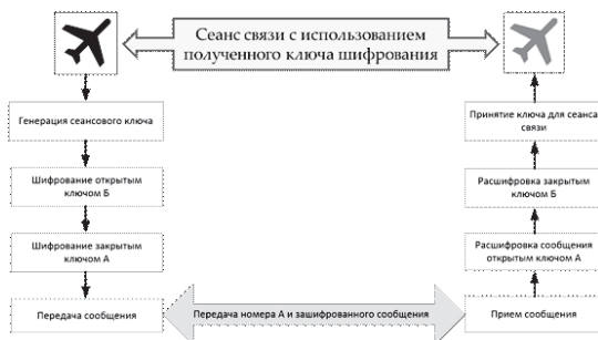
Рис. 2. Передача сгенерированного ключа сессии безопасной связи.
