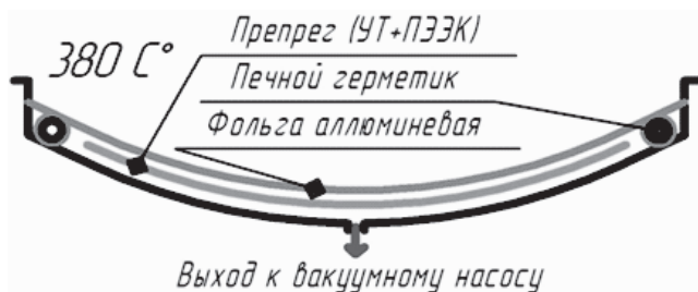
Рис. 2. Схема оснастки получения углепластика криволинейной формы.
