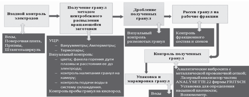
Рис. 1. Объединенная схема технологического процесса и оборудования, участвующего в контроле качества процесса получения гранул титановых сплавов.
