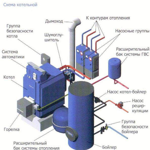
Рис. 1. Устройство котельной установки [3].
