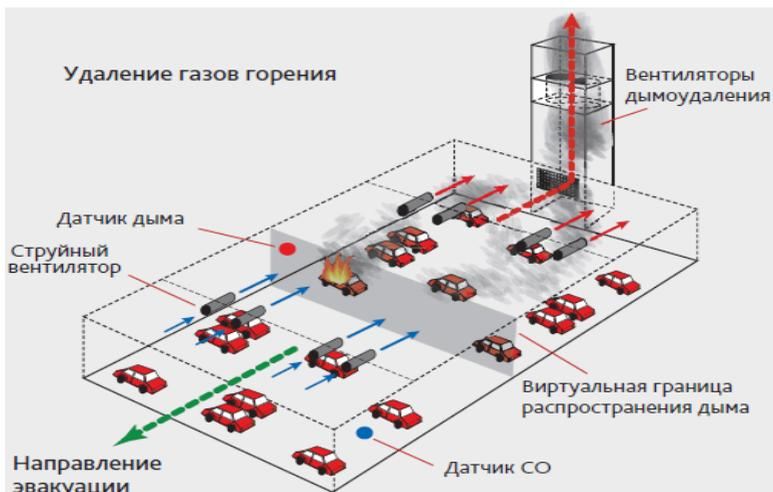
**Рис.3.** Продольная схема дымоудаления при пожаре на автостоянке.
