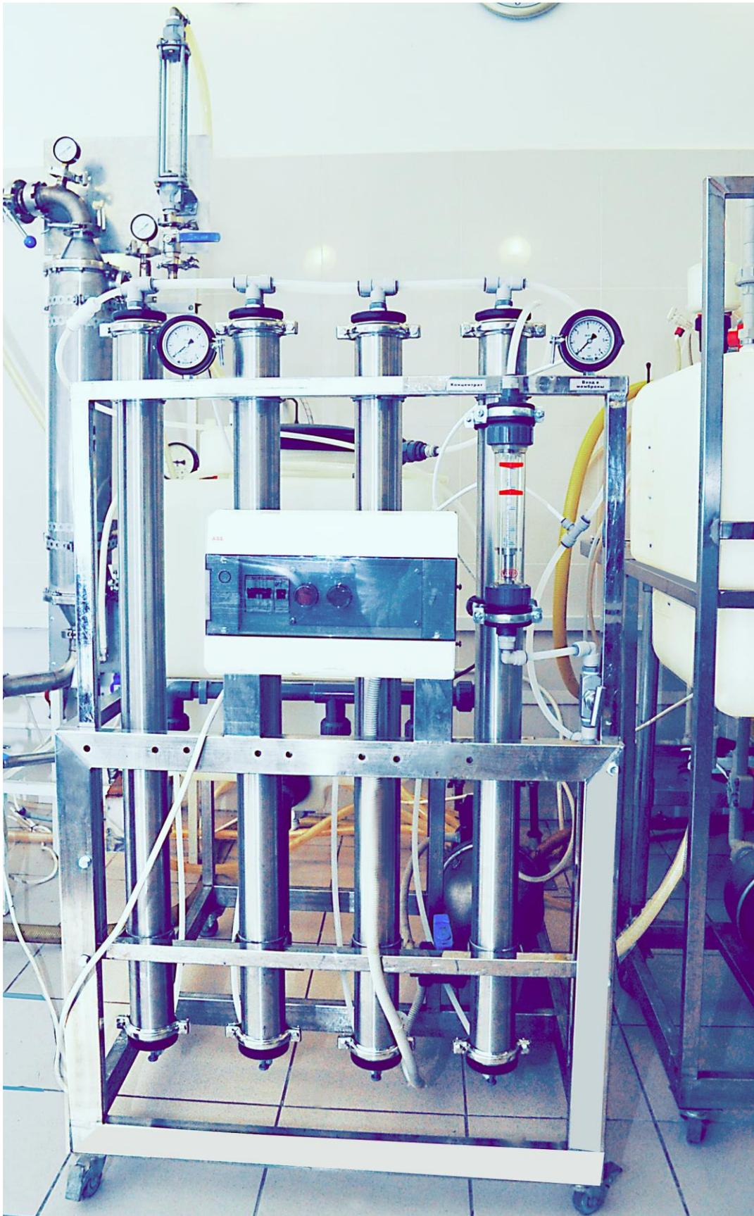
Фотография 23. Блок мембранного концентрирования 70 Да
