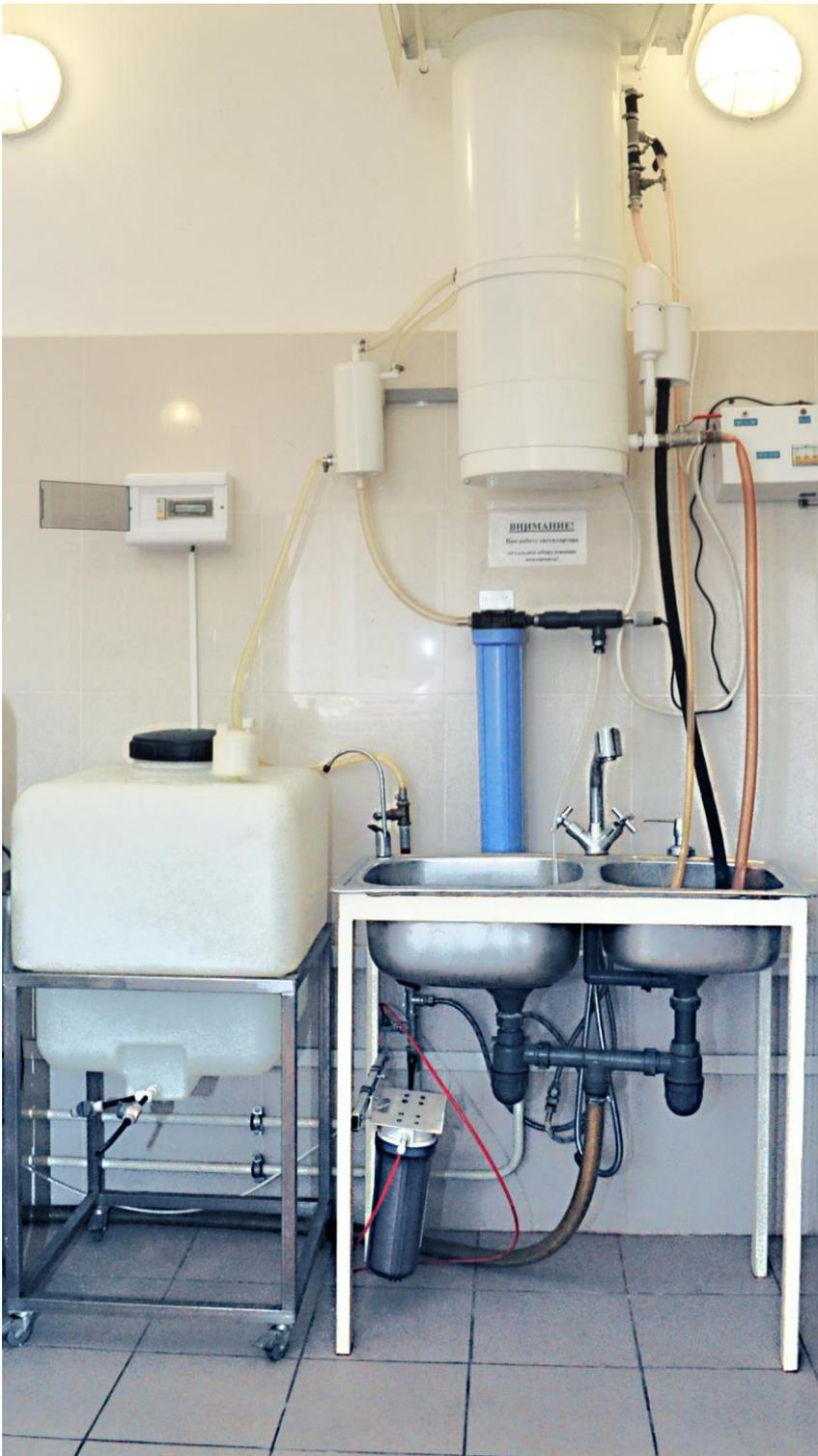
Фотография 24. Блок подготовки воды: дистилляция + доочистка на ионообменных смолах (катионная и анионная)
