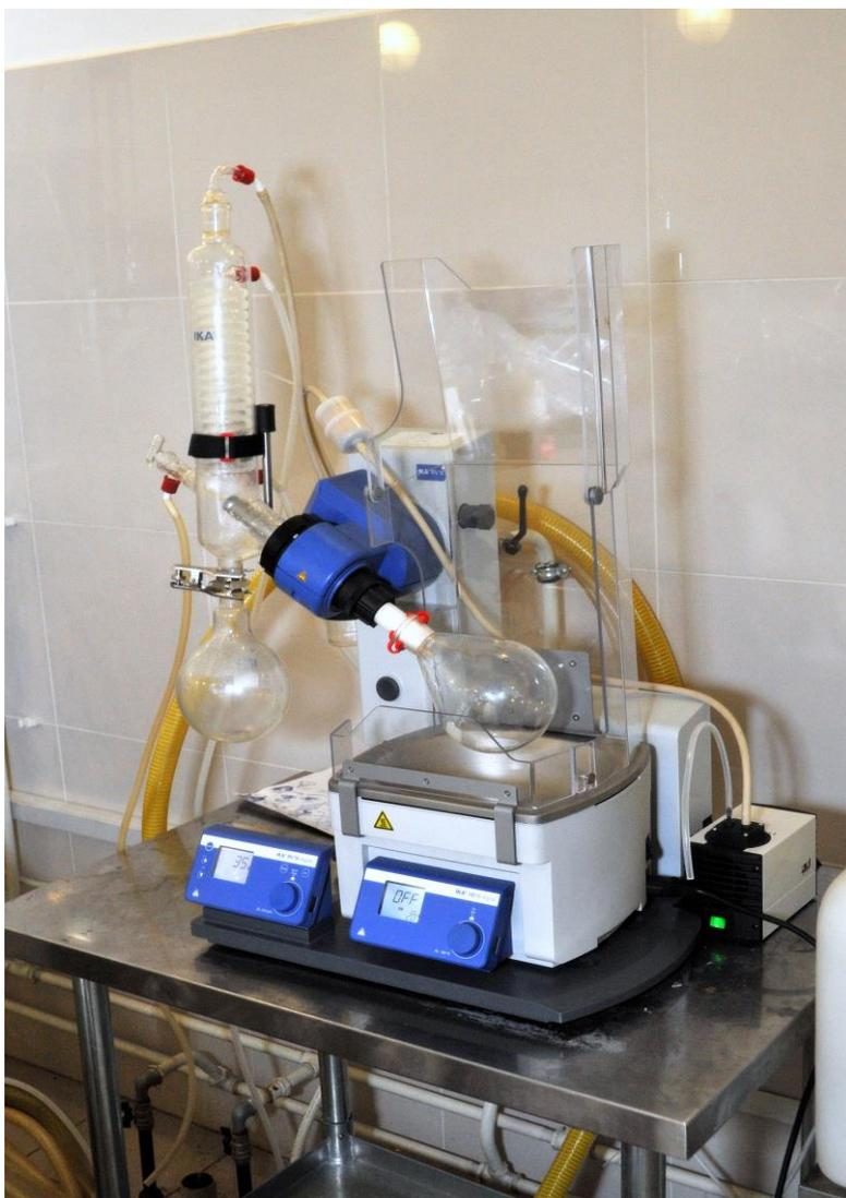
Фотография 3. ИКА RV 10 digital ИКА-Werke GmbH&Co.Kg, Германия
