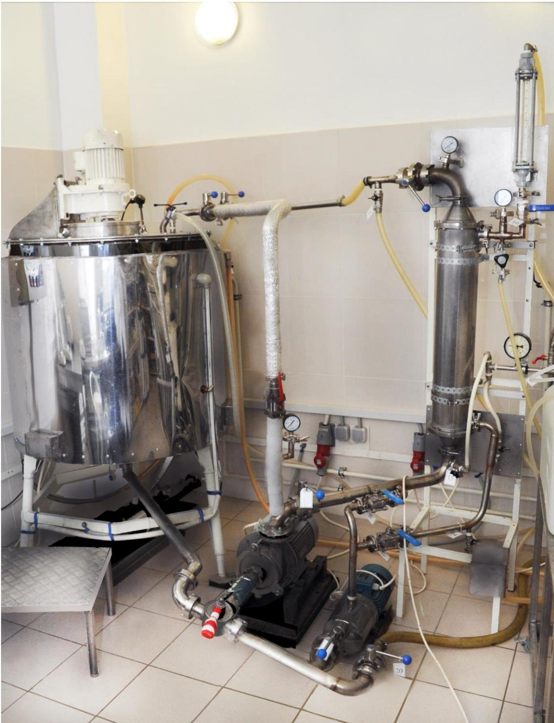
Фотография 21. Блок ультраfiltrации 150 кДа
