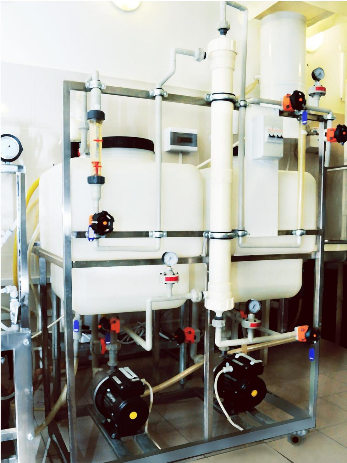
Фотография 22. Блок ультраfiltrации 50 кДа
