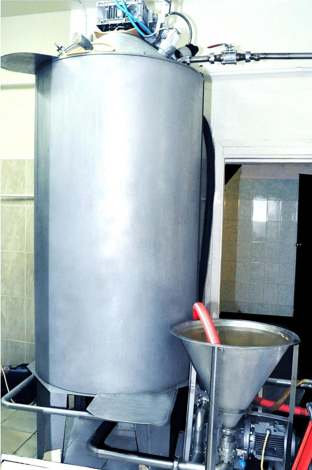
Фотография 20. Основной реактор с мешалкой и гомогенизатором
