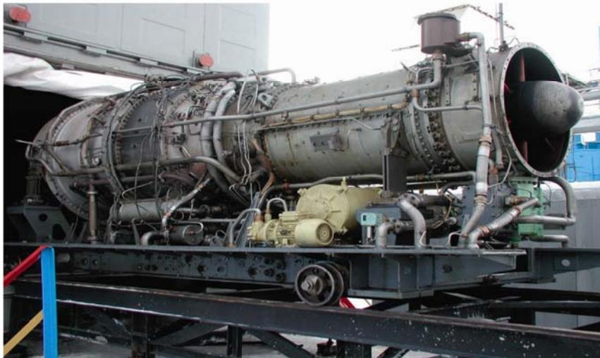
Рис. 2. Внешний вид газоперекачивающего агрегата ГПА-16 с двигателем ДГ-90
