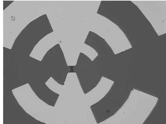
Рис.1. Фотография образца с джозефсоновским бикристаллическим переходом (темный мостик в центре), интегрированным с логопериодической антенной
