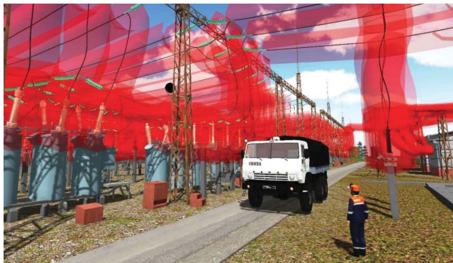
Рис. 2. Опасные зоны смоделированы как полупрозрачные трубки, отдельно для персонала и техники
