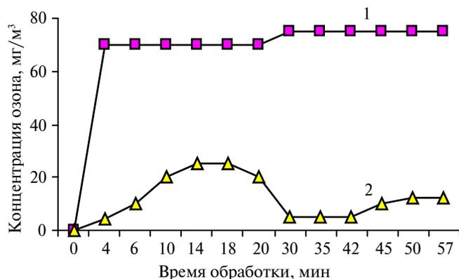
Рис. 2. Изменение концентрации озона в молокопроводе: 1, 2 — соответственно на входе и выходе
