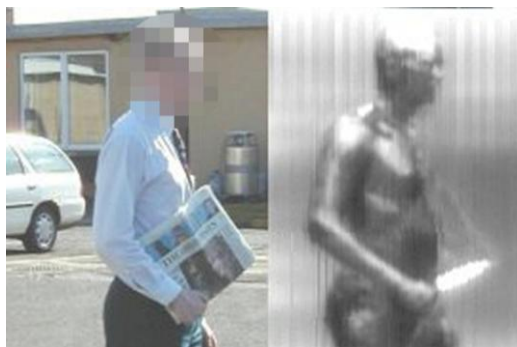
Рисунок 2. Терагерцовое излучение имеет высокую проникающую способность в ряде материалов, что может быть использовано в системах обеспечения безопасности. Представлены оптическое и терагерцовое изображения человека с металлическим предметом (ножом), помещенным в газету [14]. Снимок сделан на частоте 0,094 ТГц в пассивном режиме (без использования источника ТИ) на расстоянии около 15 метров.
