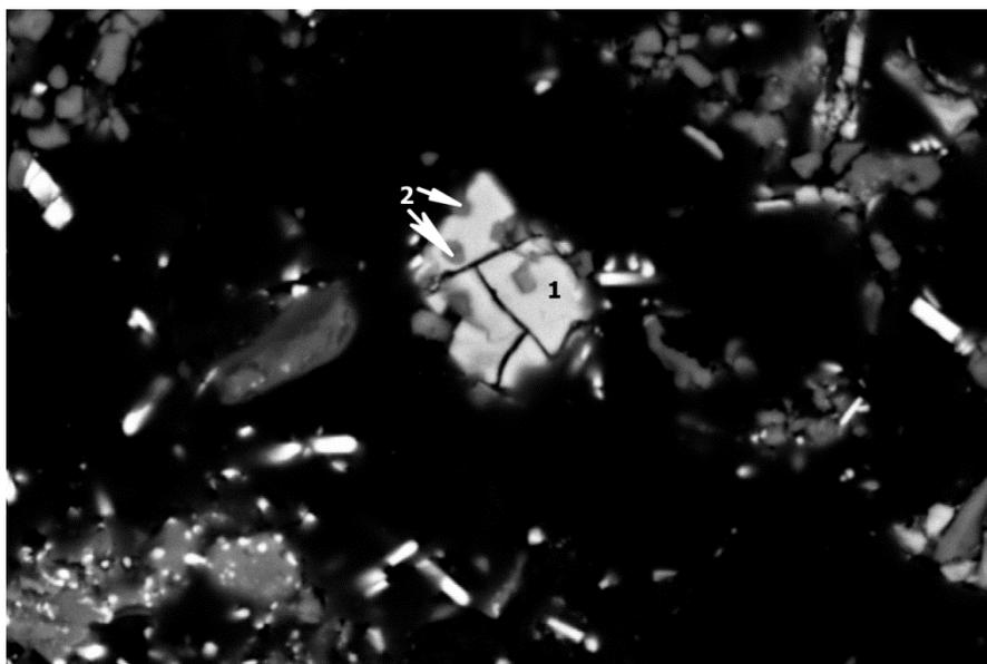
Рисунок 1. Сростание иттрийсодержащего алланита (2) с силикатом иттрия (1). РЭМ-фотография в отраженных электронах. Ширина поля зрения 100 мкм.
