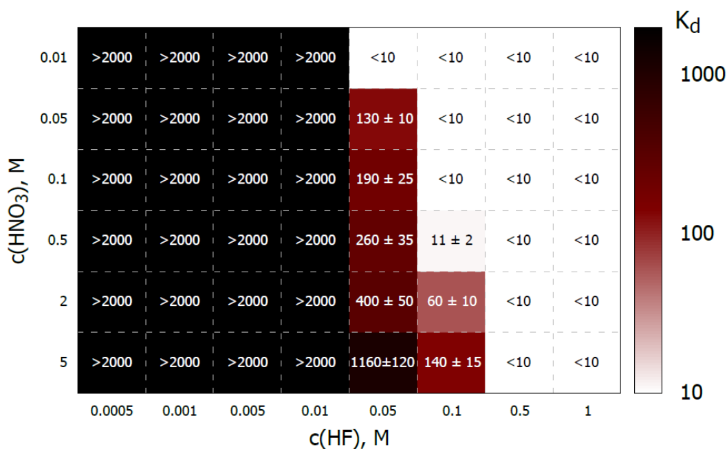
Рисунок 7. Коэффициенты распределения Zr(IV) на экстракционно-хроматографическом сорбенте LN в смесях HF и HNO 3 .
