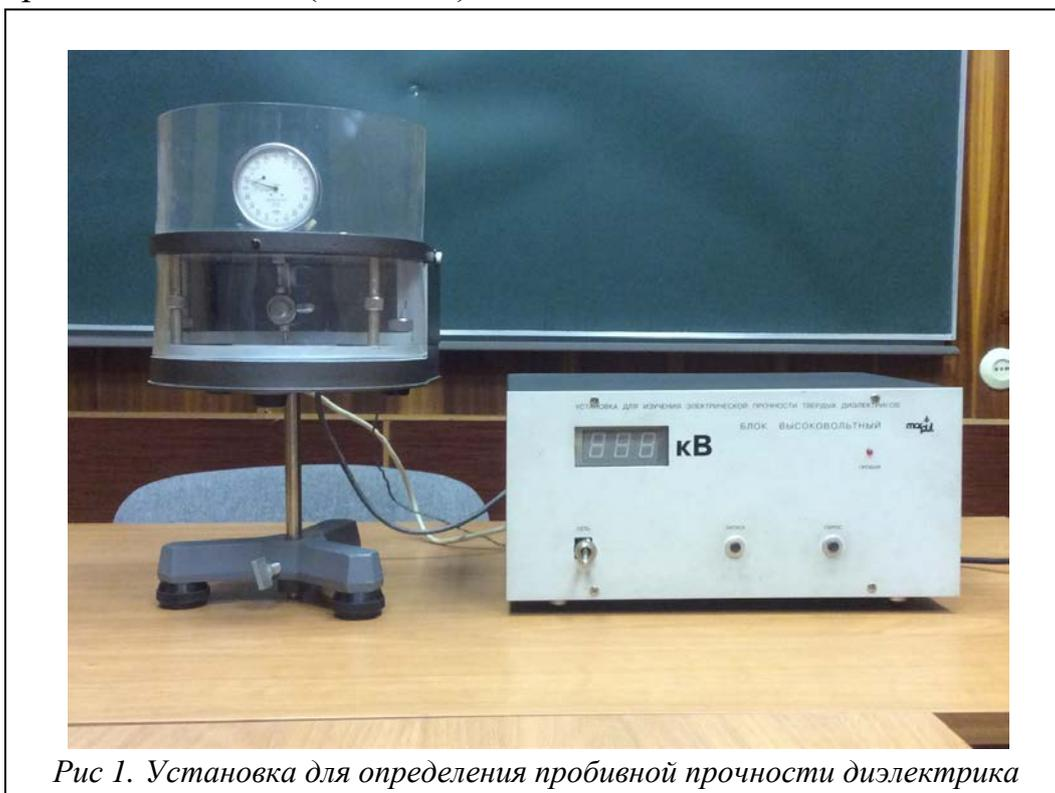
*Рис 1. Установка для определения пробивной прочности диэлектрика*
