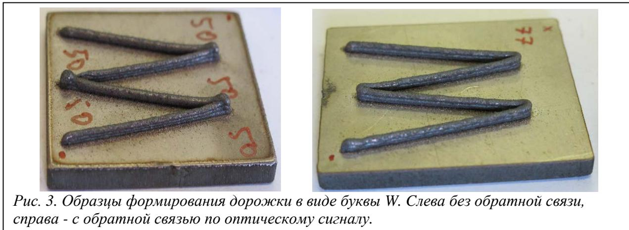
Рис. 3. Образцы формирования дорожки в виде буквы W. Слева без обратной связи, справа - с обратной связью по оптическому сигналу.
