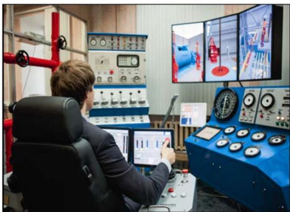
Рис. 8. Полномасштабный буровой симулятор DrillSim-5000
