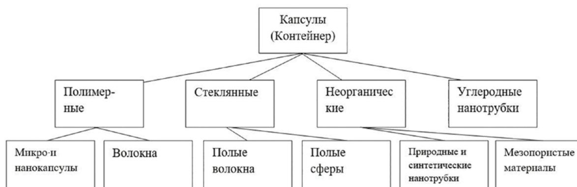
Рис. 1. Капсулы (контейнеры) различного происхождения для использования в полимерных композиционных smart-материалах
