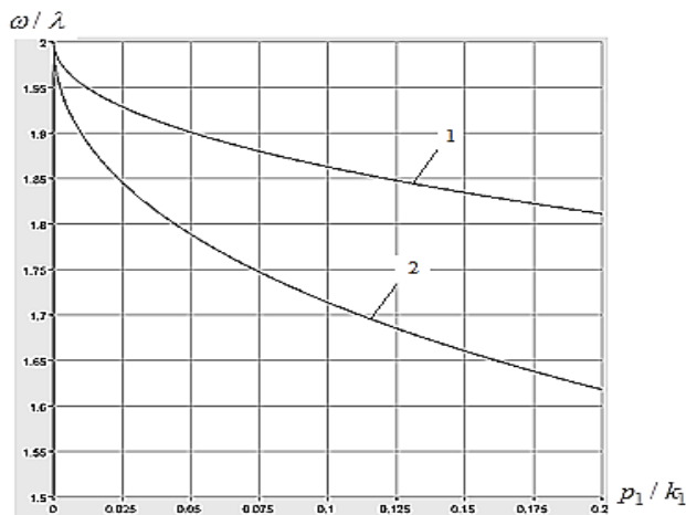
Рис.5. Граница области устойчивости для ротора -1 и плавающего кольца (в сечении б) - 2.
