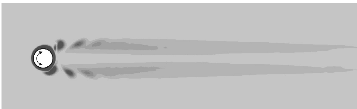
Рис. 3. Мгновенное поле завихренности в случае обтекания вязкой жидкостью осциллирующего цилиндра при \alpha = 4 , f = 4
