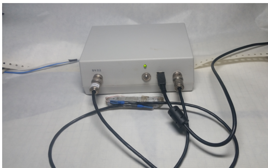
Рис. 4. Внешний вид устройства для контроля параметра, характеризующего акустическую нелинейность
