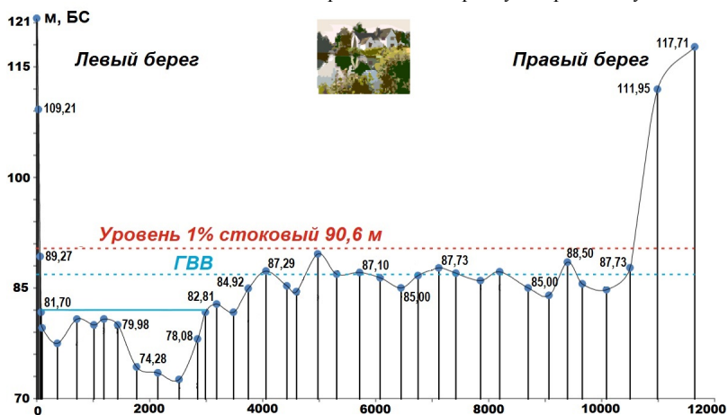
Рис. 1 Поперечный профиль долины реки Лены (п. Кангалассы) с уровнем 1% обеспеченности (красный) и ГВВ (горизонтал высокие воды) (голубой).
