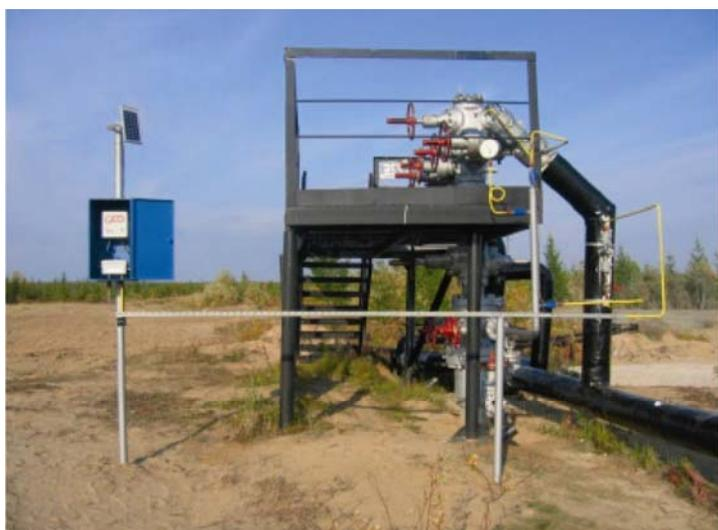
Рис. 7. Газопневматический комплекс управления плунжерным лифтом
