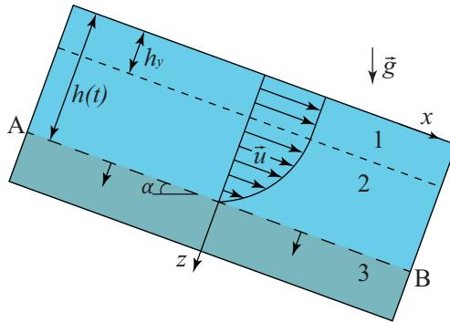
Рис. 1: Схема потока и система координат.  $h(t)$  — полная глубина потока,  $h_y$  — толщина слоя, движущегося как твёрдое тело при наличии предела текучести в реологической модели (область 1), 2 — сдвиговый слой, 3 — материал, лежащий на дне, который может вовлекаться в движение, пунктирная линия АВ — фронт разрушения, то есть нижняя граница потока, движущаяся в сторону увеличения  $z$  при наличии захвата.
