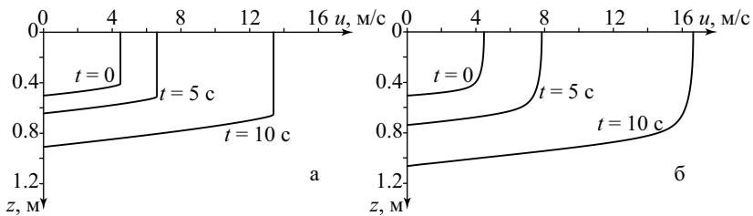
Рис. 2: Профили скорости в различные моменты времени в захватывающих донный материал потоках среды Хершеля-Балкли с параметрами  $\rho = 500 \text{ кг}/\text{м}^3$ ,  $\tau_y = 1000 \text{ Па}$ ,  $K = 0.044 \text{ кг}/\text{м}$ ,  $n = 2$  и среды Кресса с параметрами  $\mu_0/\rho = 2.52 \text{ м}^2/\text{с}$ ,  $\mu_1/\rho = 0.29 \cdot 10^{-2} \text{ м}^2/\text{с}$ ,  $k_c = 1.153 \text{ с}$ .  $\tau_c = 1200 \text{ Па}$ ,  $\alpha = 30^\circ$ .
