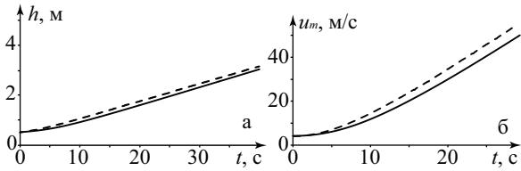
Рис. 3: Зависимости глубины  $h$  и средней скорости  $u_m$  от времени в захватывающих донный материал потоках сред Хершеля-Балкли (сплошные кривые) и Кросса (пунктирные кривые). Параметры те же, что на рис. 2.
