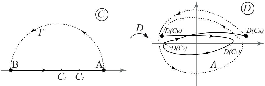
Рис. 5: Отображение  $\mathbf{d} = D(\Gamma)$  контура  $\Gamma$  функцией, задающей дисперсионное уравнение, в случае, когда в верхней полуплоскости  $C \in \mathbb{C}$  (т.е. внутри контура  $\Gamma$ ) нет корней дисперсионного уравнения.
