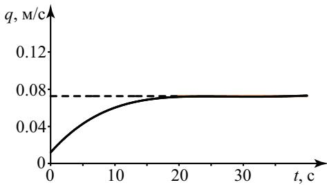
Рис. 4: Скорость захвата, полученная в расчёте (сплошная кривая), и асимптотическое значение (пунктирная линия) при больших временах для модели Хершеля-Балкли с теми же параметрами, что на рис. 2.
