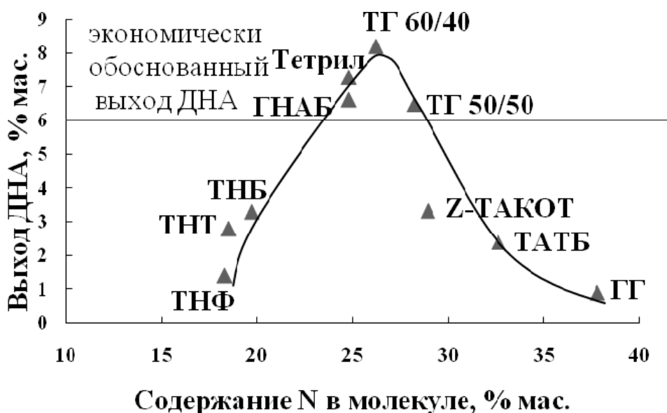
Рис. Зависимость выхода ДНА от содержания азота в индивидуальных ВВ и смесевых зарядах.
