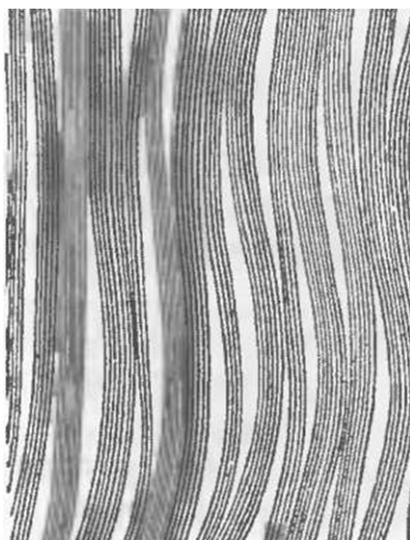
Рисунок 1.9. Схематичное изображение ленточной структуры углеродного волокна [48]
