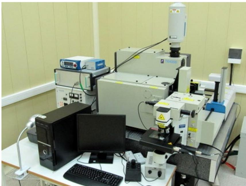
Рисунок 2.5. Общий вид спектрометра комбинационного рассеяния света Horiba Jobin Yvon T64000.
