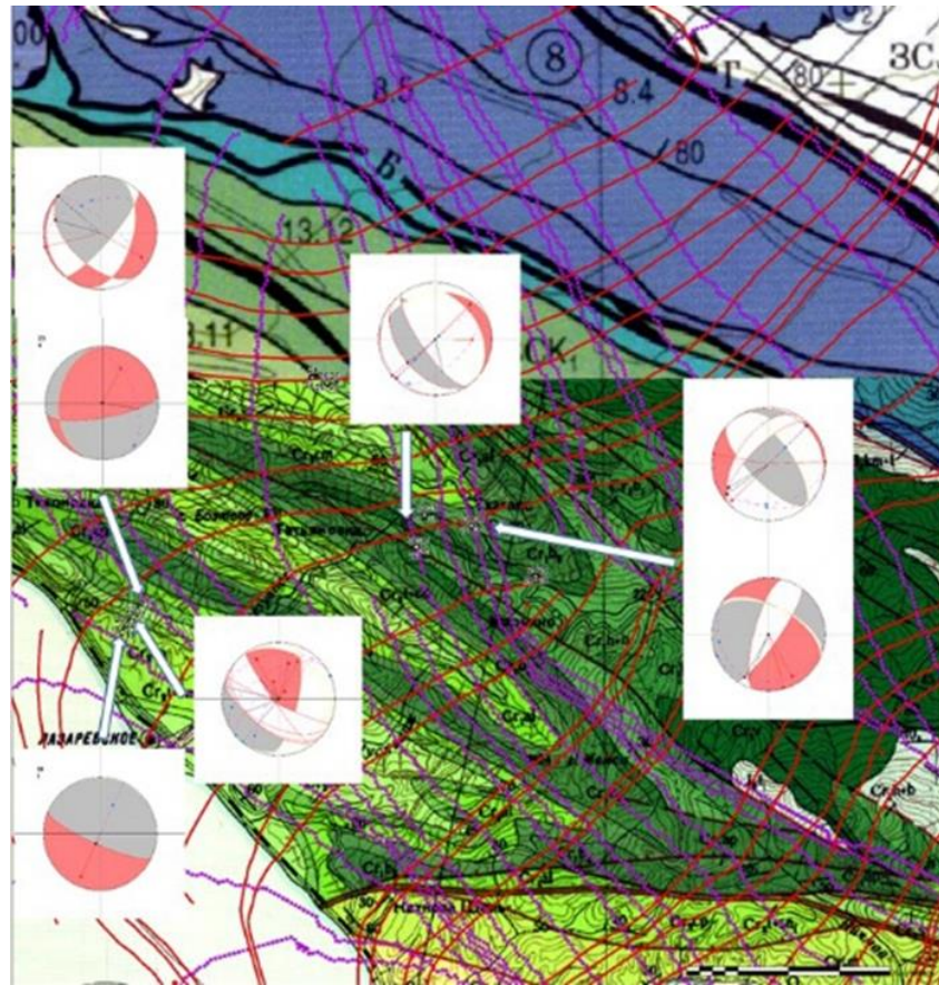
Рис. 12. Напряженное состояние и линии вытянутости гидросети, подсчитанные программой LESSA, в районе пос. Лазаревское. Условные обозначения на рис. 1.
