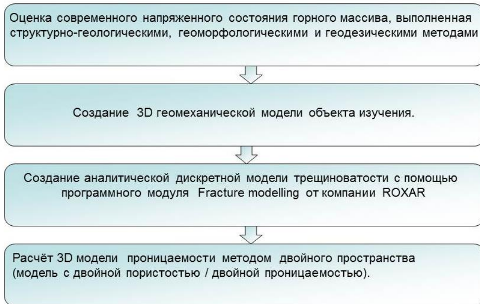
Рис. 1. Технология оценки вторичной флюидной проницаемости горных пород
