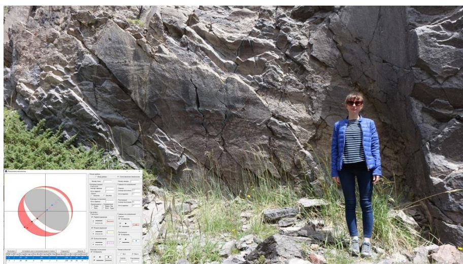
Рис. 5. Трещиноватость в голоценовых лавах района Поляны Азау и стереограмма борозд скольжения.
