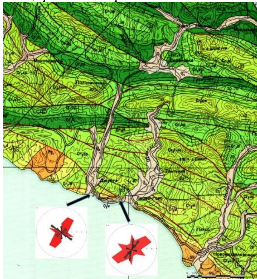
Рис. 13. Характер трещиноватости в районе пос. Лермонтово и Дзюбга.
