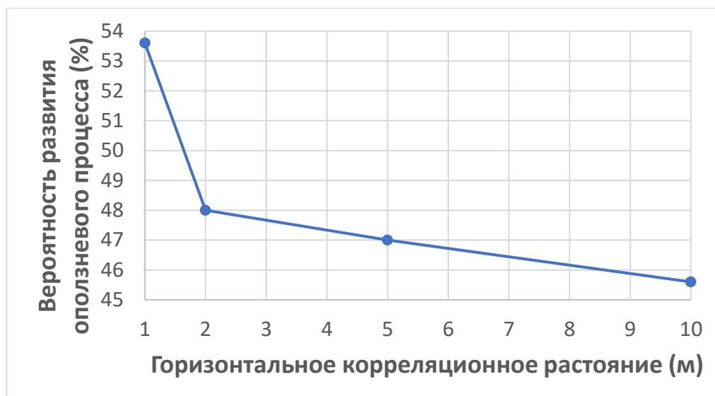
**Рис. 8.** Зависимость вероятности развития оползневого процесса от горизонтального корреляционного расстояния
