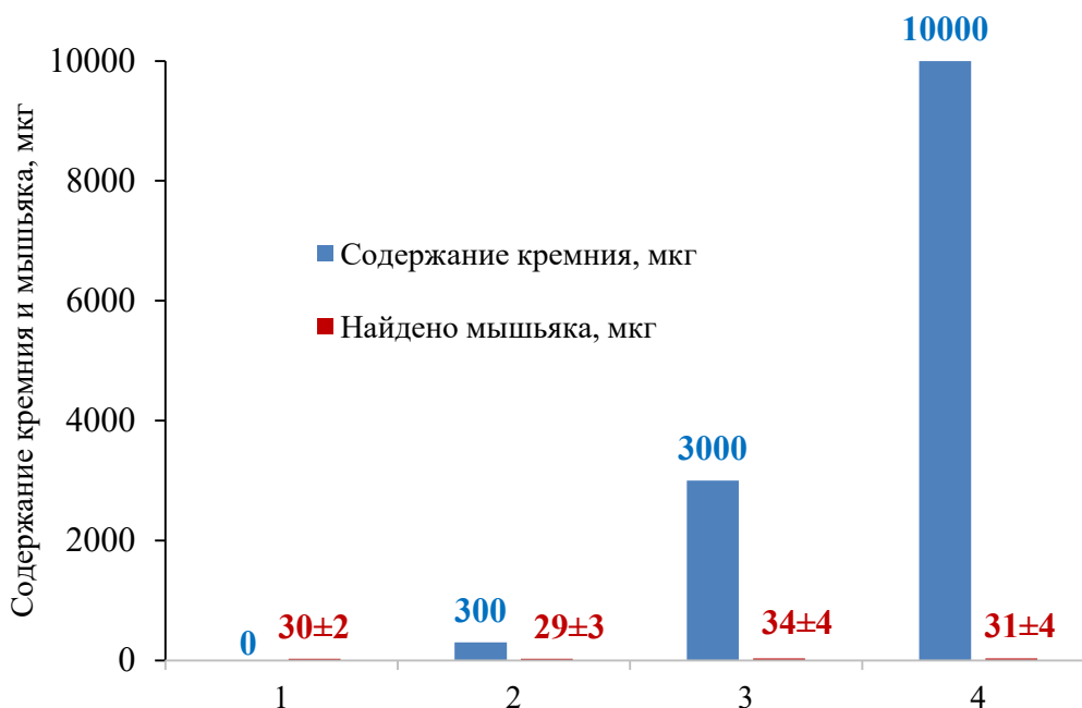
Рис. 4. Влияние кремния на РФ-определение мышьяка(V); (V=25 мл, n=4, P=0,95, содержание As=30 мкг)
