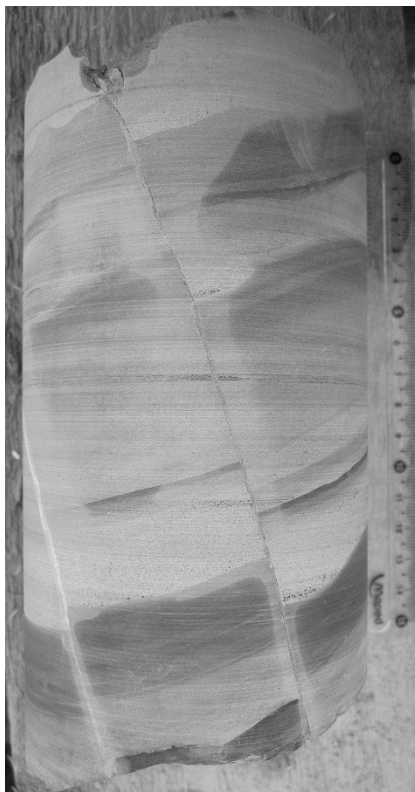
Рисунок 1. Прожилков осветления, выполняющий плоскость микросброса-взброса, переходящий с расширением вверх в субпослойное осветление.
