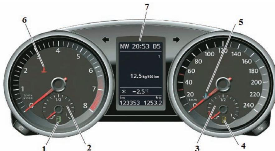
Рис. 5. Комбинация приборов у автомобилей Volkswagen Passat EcoFuel, где 1 – контрольная лампа работы на природном газе, 2 – указатель запаса газа, 3 – указатель уровня бензина, 4 – контрольная лампа резервного запаса бензина, 5, 6 – контрольные лампы температуры охлаждающей жидкости, 7 – многофункциональный дисплей
