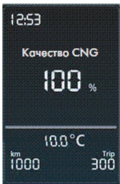
Рис. 6. Индикатор, показывающий качество заправляемого природного газа на автомобилях Volkswagen Golf Variant Blue Motion
