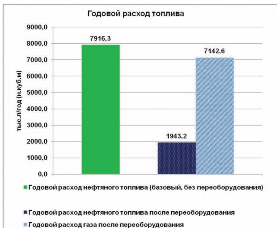
Рис. 2.2. Годовой расход топлива до и после переоборудования
