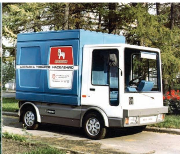
*Электрические грузовички из серии «Пони» не стали перспективными во многом по вине тяжёлых аккумуляторов. Так, на алюминиевой модели 2802-01 неудачная развесовка привела к тому, что порожняя машина не могла тронуться с места на скользкой поверхности, а вариант 2802-02 брал на борт максимум 100 кг, то есть возил фактически сам себя*
