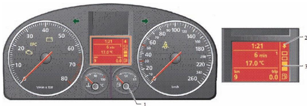
Рис. 3. Комбинация приборов у автомобилей Volkswagen Touran EcoFuel и Caddy EcoFuel (Midline), где 1 – индикатор уровня газа, 2 – контрольный индикатор режима аварийной работы на бензине, 3 – индикатор уровня бензина
