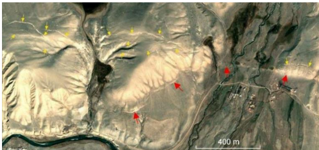
Рис. 7.54. Оползневые заколы (обозначены желтыми стрелками) в висячем крыле молодого надвига (обозначен красными стрелками) на северном борту долины р. Какракуджур, Центральный Тянь-Шань (41.9245° с.ш., 75.992° в.д.)
