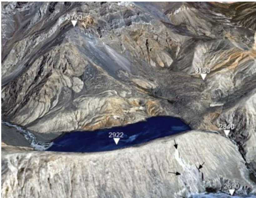
Рис. 4.46. Завальная плотина оз. Башколь, образованная фронтальной частью оползневого тела. Маленькими черными стрелочками обозначен цирк молодого оползня на левом борту долины р. Учкёль, возможно образовавшегося вследствие фильтрации воды из озера через узкий гребень. Перспективное изображение Google Earth
