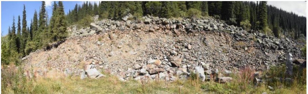
Рис. 3.35. Небольшой карьер в центральной части завальной плотины Большого Алматинского озера в борту которого отчетливо видно (на увеличенном фрагменте слева), что крупно-глыбовая панцирная фации отложений имеет мощность, фактически, "в одну глыбу" и подстиляется интенсивно раздробленным щебнем того же состава без видимой переходной зоны
