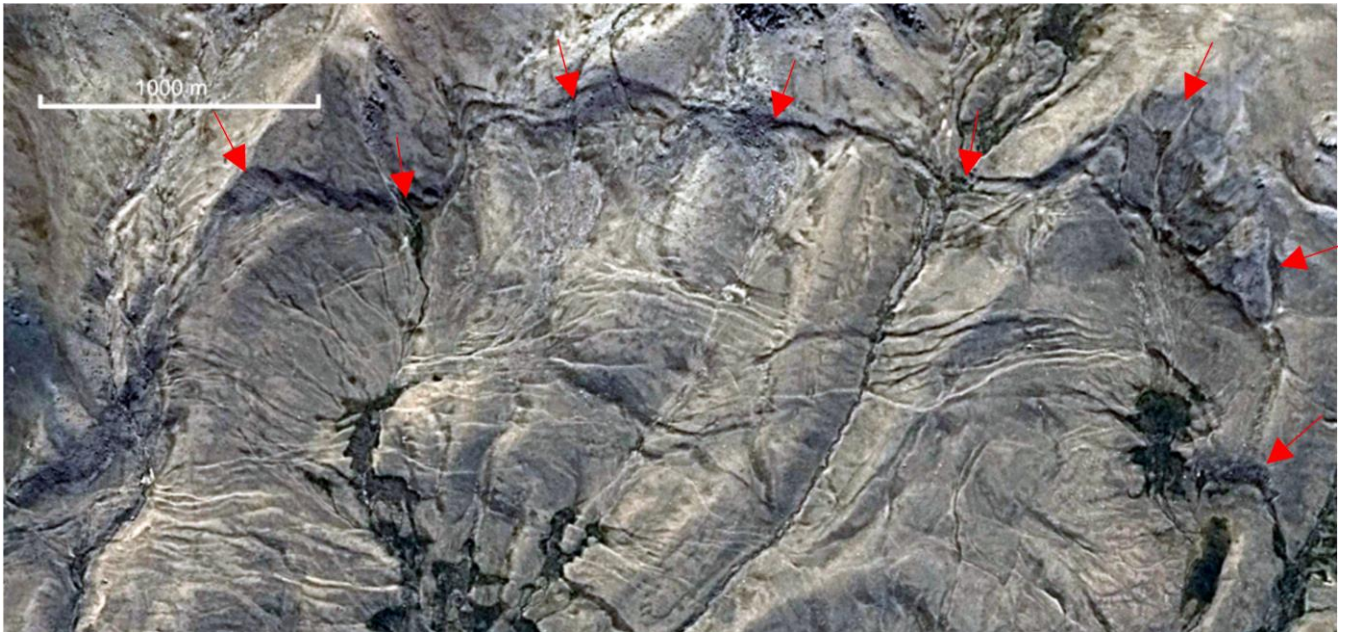
Рис. 3.2. Плановое изображение головной части оползня Терс в северо-западной части Киргизии с отчетливо выраженной стенкой отрыва протяженностью более 5 км и уступами и трещинами в теле оползня. Красными стрелочками обозначена основная стенка отрыва
