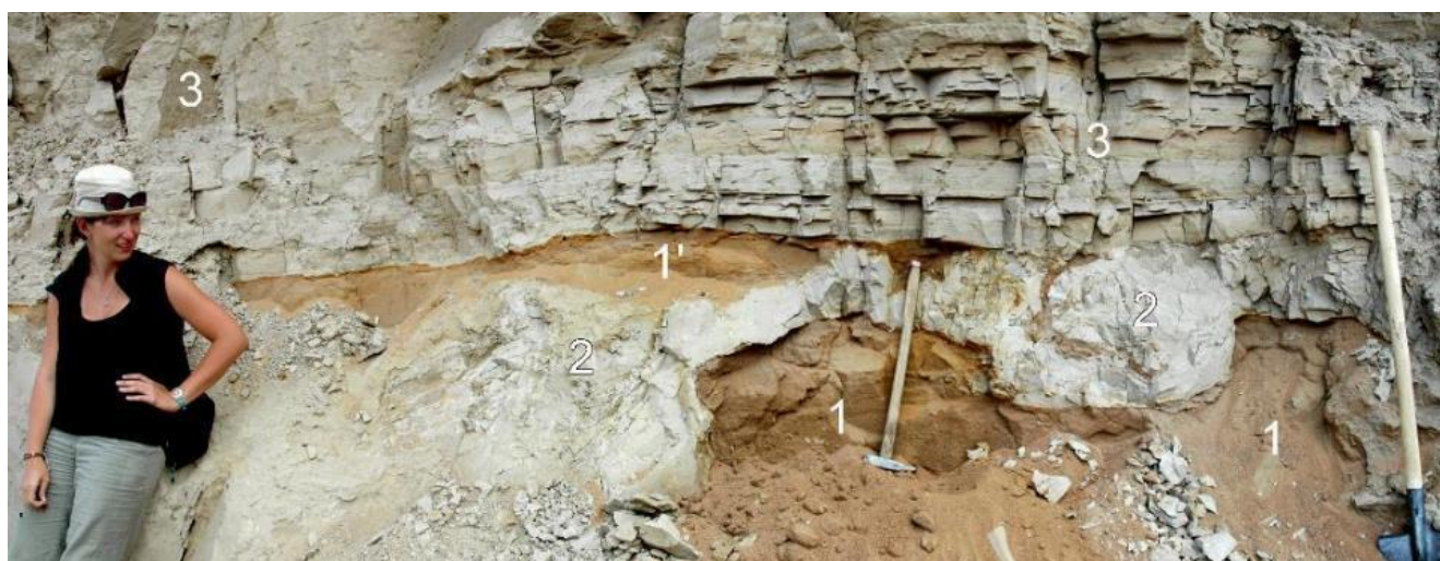
Рис. 7.25. Следы разжижения в озерных отложениях, накопившихся в хвостовой части подпрудного озера, образованного Карачаулинским оползнем. 1 – крупнозернистый песок в основании разреза озерных отложений, разжиженный и выброшенный на дно водоема (1'), т.н. "горизонт события"; 2 – нижняя часть разреза озерных илов с разрушенной слоистостью, погружившихся в разжиженный песок; 3 – основная, недеформированная часть разреза озерных илов с выраженной слоистостью
