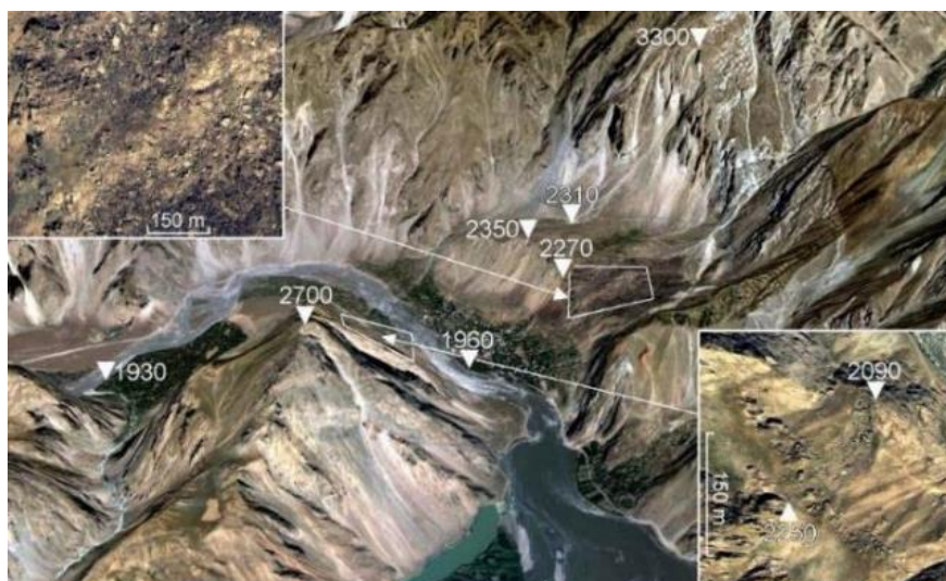
Рис. 7.44. Оползень Шидз. Перспективное изображение Google Earth. Во врезках показаны глыбы на поверхности размывтой завальной плотины, большая часть тела которой сохранилась на правом, Таджикском, борту долины, а небольшой фрагмент уцелел на левом, Афганском, борту. Бровка цирка на отметке 3300 м
