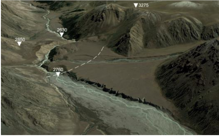
Рис. 4.29. Прорванная завальная плотина объемом около 60 миллионов м 3 и высотой почти 200 м в верховьях р. Чилик, Южный Казахстан (43.03° с.ш., 77.51° в.д.). Около 15% его тела было размыто или погребено конусом выноса р. Кайракты. Белой пунктирной линией обозначена предполагаемая верховая граница оползневого тела. Многочисленные террасовые уровни на правом берегу р. Кайракты свидетельствуют о многоэтапном процессе прорыва завальной плотины. Перспективное изображение Google Earth
