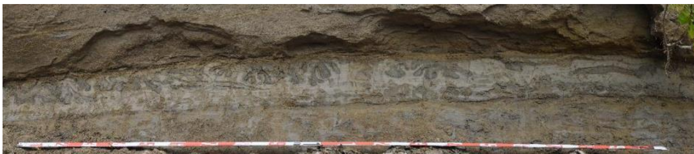
Рис. 7.24. Следы предположительно сейсмогенного разжижения грунтов в отложениях подпрудного озера в долине р. Мин, КНР
