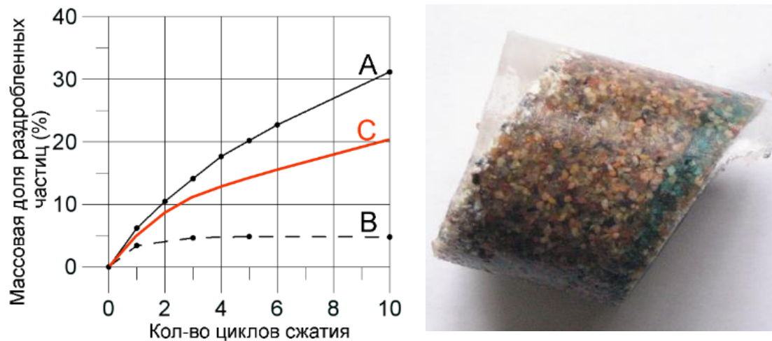
Рис. 3.77. Слева – изменение гранулометрического состава в зависимости от числа циклов "сжатие – снятие нагрузки" в экспериментах А, В, С. Справа – сохранение взаимного положения разноокрашенных частиц после эксперимента "С"
