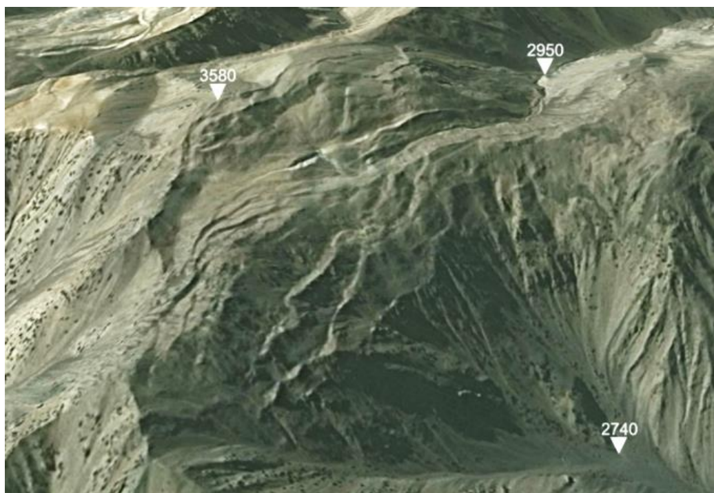
Рис. 8.1. Оползневые заколы на левом борту долины р. Зеравшан над кишлаком Рогив ( 39.374^{\circ} с.ш., 69.335^{\circ} в.д.). Перспективное изображение Google Earth. Объем массива, который может быть вовлечен в обрушение, составляет десятки миллионов кубометров
