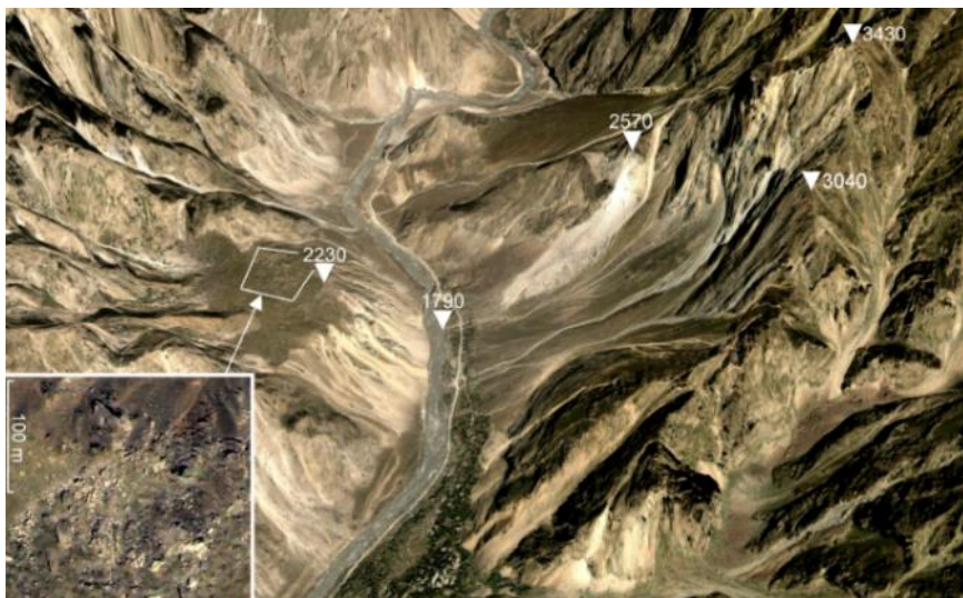
Рис. 7.45. Оползень Вознавд (первичная каменная лавина) в условиях фронтального ограничения. Перспективное изображение Google Earth. Бровка цирка обозначена отметками 2570, 3430 и 3040 м. Во врезке показаны глыбы на поверхности фронтальной части размывтой завальной плотины с отметкой 2230 м, сохранившейся на левом, Афганском, борту долины
