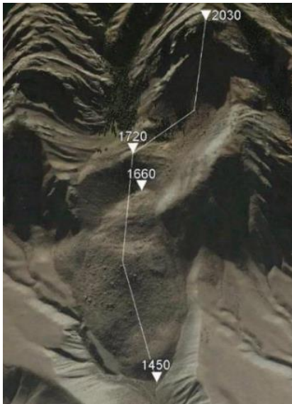
Рис. 4.33. Вторичная каменная лавина у северного подножия хребта Ирен-Хабырга в китайской части Тянь-Шаня (44.127° с.ш., 84.426° в.д.) длиной 1.34 км. Полная длина измерялась вдоль ломаной линии, а длина собственно вторичной лавины – между точками с отметками 1720 и 1450 м
