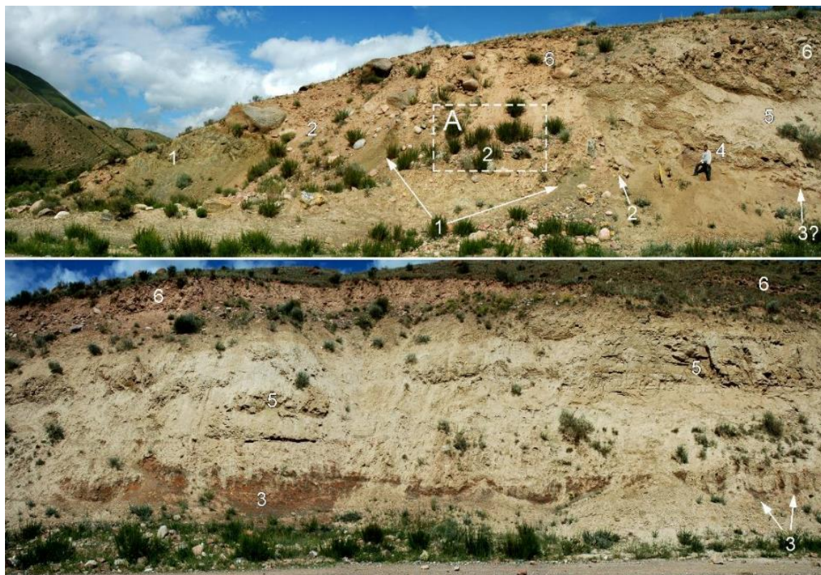
Рис. 7.64. Вверху – обнажение в уступе дорожной полки вблизи впадения р. Ковюксу в р. Кокомерен с последовательностью озерных отложений и с признаками многоэтапных молодых тектонических деформаций. Внизу – продолжение этого обнажения в нескольких десятках метров выше по течению р. Кокомерен. 1 – раздробленные и милонитизированные палеозойские отложения – породы зоны разлома; 2 – глыбы палеозойских метаморфизованных песчаников, перемешанные с хорошо окатанными валунами руслового аллювия (см. рис. 7.65); 3 – базальный горизонт отложений подпрудного озера – смесь щебня метаморфизованных песчаников с левого борта долины и неогеновых красцветов с правого борта; 4 – наклоненная и нарушенная разрывом последовательность глин, песков и мелких галечников, накопившихся в подпрудном озере; 5 – тонкослоистые озерные илы белесого цвета; 6 – селевые отложения, срезающие и перекрывающие всю вышеописанную последовательность отложений. А – примерное положение обнажения, показанного на рис. 7.65
