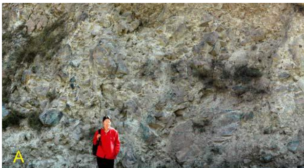
Рис. 3.48. Характер отложений панцирной (А) и внутренней (В) фаций в теле Арашанского оползня
