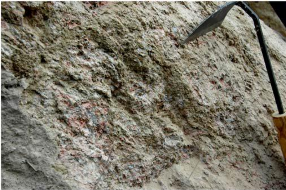
Рис. 3.49. Характерное строение раздробленных метаморфизованных песчаников (А) и раздробленных гранитов (В) в составе внутренней фации Кокомеренского оползня
