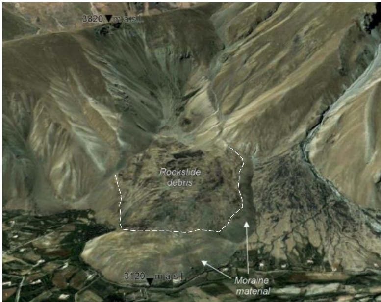
Рис. 4.7. Перспективное изображение Имомского оползня на левом борту долины р. Гунт на Памире (космический снимок Google Earth). Фронтальная и боковые части его тела сложены моренным материалом, вытолкнутым вперед и в стороны при формировании оползня в скальном массиве, а центральная – обломками коренных пород. Граница между ними показана белой пунктирной линией
