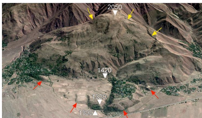
Рис. 7.59. Оползневой склон вблизи кишлака Хуфак у северного подножия хр. Петра Первого в Таджикистане (стенка отрыва обозначена желтыми стрелочками) и уступ высотой около 20 м у подножия склона, который, возможно, является выходом фронтальной части кругоцилиндрической (в разрезе) поверхности скольжения
