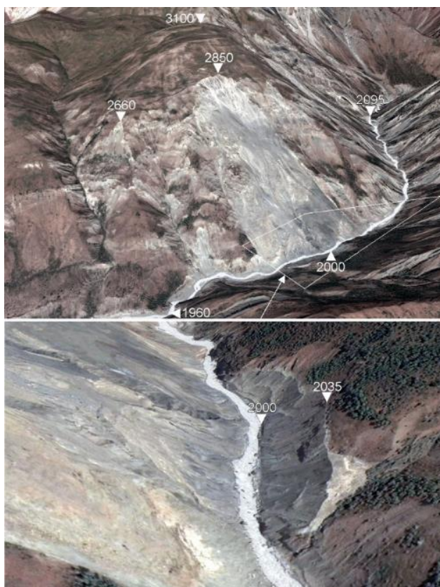
Рис. 8.14. Оползнеопасный склон в устье р. Рагноу. Перспективное изображение Google Earth (съемка 13.08.2008 г.). Видны дугообразные трещины между отметками 2850 и 3100 м. Внизу – увеличенное изображение сула реки со следами недавнего оползневого перекрытия
