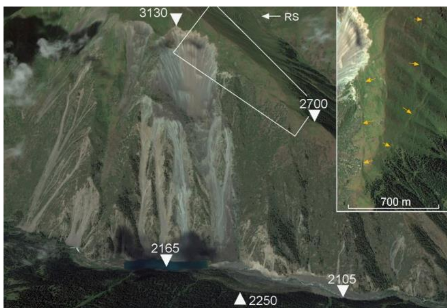
Рис. 7.4. Завальная плотина в долине р. Б. Орюкты. Каменная лавина распространилась вниз по долине до отметки 2105 м. На гребне рядом с цирком видны оползневые заколы (отмечены на врезке оранжевыми стрелочками). RS – небольшой оползень в скальном массиве в боковой долине. Перспективное изображение Google Earth
