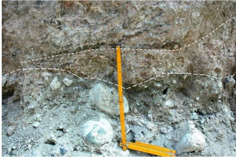
Рис. 3.62. Интенсивно раздробленные граниты базальной фации в основании тела Арашанского оползня, залегающие на, предположительно, ледниковых (возможно, водно-ледниковых) отложениях и перекрытые менее раздробленным материалом внутренней фации
