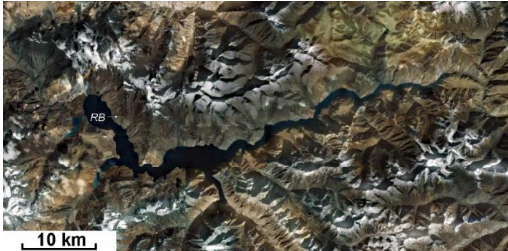
Рис. 4.50. Космический снимок Сарезского озера. RB – предполагаемый "Правобережный оползень" (Шеко, Лехатинов, 1970; Федоренко и др., 1981), в случае обрушения которого возможен перелив воды через плотину
