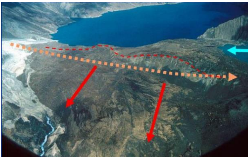
Рис. 5.16. Перспективное изображение Google Earth Аксуйской завальной плотины объемом около 1 \text{ км}^3 в Киргизском хребте со стороны оползневого цирка. Расстояние между отметками 1785 м и 1570 м составляет примерно 2.5 км
