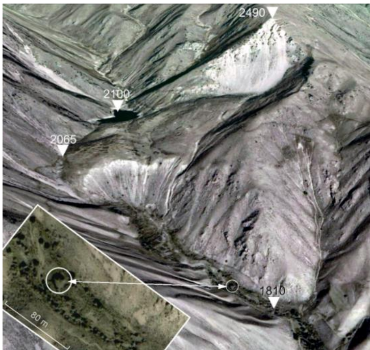
Рис. 4.47. Кёльсайский оползень в гранитах объемом \sim 10^6 м 3 сопровождавшийся выбросом вниз по течению ручья отраженной каменной лавины небольшого объема, прошедшей расстояние \sim 750 м вплоть до отметки 1810 м. На врезке показаны крупные глыбы размером до 10 м, которые не могли быть перемещены, к примеру, селевым потоком, так как отсутствуют следы прорыва озера. Перспективное изображение Google Earth
