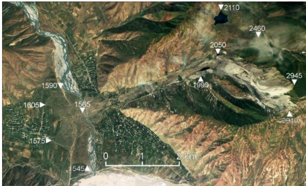
Рис. 4.38. Космический снимок Хаитской каменной лавины. После выхода из узкой долины, где она двигалась в условиях бокового ограничения, обломочная масса образовала конусообразную лопасть, фронт которой обозначен отметками 1590, 1605, 1575, 1545 м
