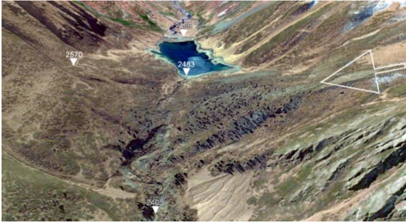
Рис. 4.53. Признаки значительных – до 12 м сезонных колебаний уровня подпрудного озера в верховьях р. Аттапкан. Уровни низкого стояния озера в момент съемки и следов высокого стояния измерялись по данным ресурса Google Earth. Стрелка указывает направление движения каменной лавины, образовавшей плотину.
