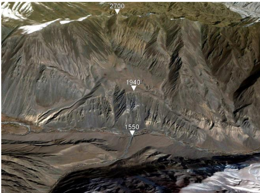
Рис. 4.30. Сильно размытая завальная плотина в долине р. Ашу (44.2° с.ш., 83.644° в.д.), фронтальная часть которой полностью уничтожена. В разрезе оползневого тела мощностью 390 м (между отметками 1940 и 1550 м) видны отдельные "слои" различного цвета и, вероятно, разного состава. Перспективное изображение Google Earth
