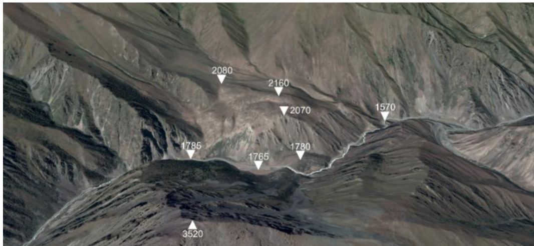
Рис. 5.16. Перспективное изображение Google Earth Аксуйской завальной плотины объемом около 1 \text{ км}^3 в Киргизском хребте со стороны оползневого цирка. Расстояние между отметками 1785 м и 1570 м составляет примерно 2.5 км
