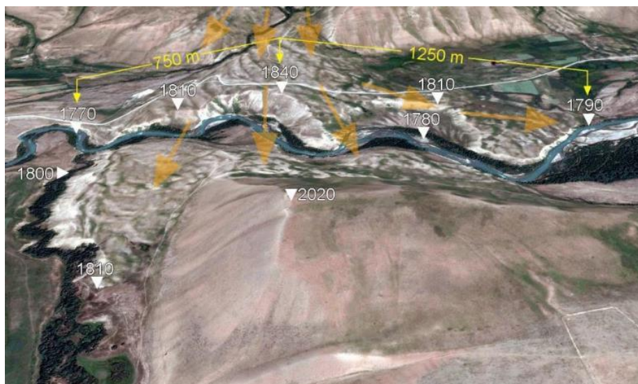
Рис. 6.13. Фронтальная часть Чукурчакской каменной лавины, вышедшей из узкой ложбины в долину р. Чаткал (41.805° с.ш., 71.15° в.д.) и распространившейся на 2 км вдоль реки по поверхности террас высотой 12-20 м. Стрелочками показано направление движения материала
