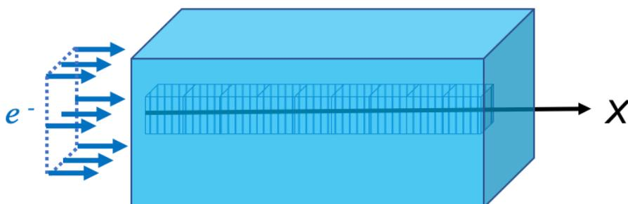
*Рис. 2.7 – Схема моделирования облучения объекта из воды в форме параллелепипеда пучком ускоренных электронов*
