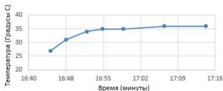
Рисунок 3. Зависимость температуры от времени при токе в 5\text{ А} .
