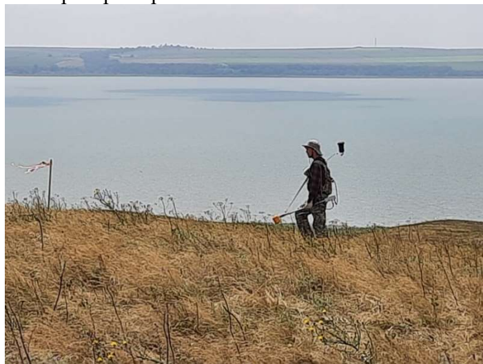
Рисунок 5. Рабочий момент магнитной съемки: оператор один производит измерения, за спиной у оператора RTK - приёмник.
