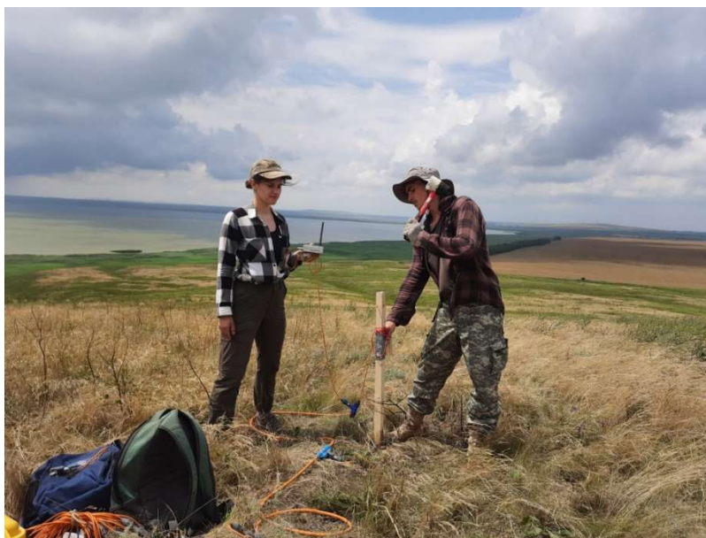
Рисунок 3. Рабочий момент сейсморазведочных исследований: возбуждение продольных волн с помощью кувалды и деревянного стержня.
