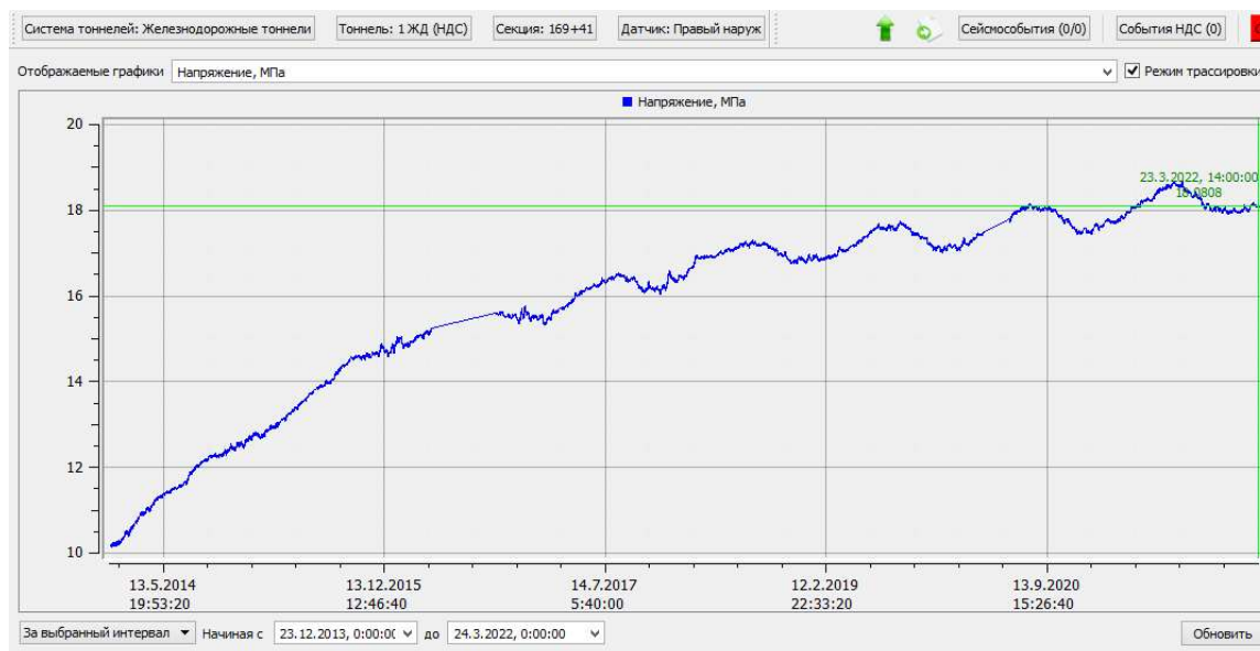
Рисунок 1. Изменения напряжений на наружном контуре обделки железнодорожного тоннеля №1 на ПК 169+41 трассы Адлер – Красная Поляна за время эксплуатации.
