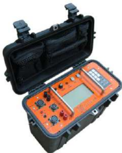
Рисунок 1. Многоэлектродная электроразведочная станция Скала48.
