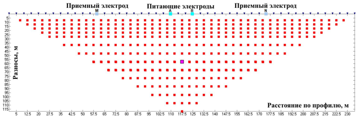
Рисунок 5. Протокол работы станции Омега-48, реализующий симметричную инверсную установку Шлюмберже. Красными точками показаны виртуальные точки записи для соответствующей установки. Синими треугольниками показаны электроды. Фиолетовая точка - точки записи для показанных положений приемных (m) и питающих (A, B) электродов
