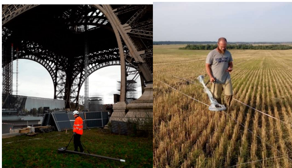
Рисунок 1. Внешний вид и процесс полевой съемки с использованием аппаратуры электромагнитного профилирования ЭМС (слева) и «ГеоВизер» (справа).
