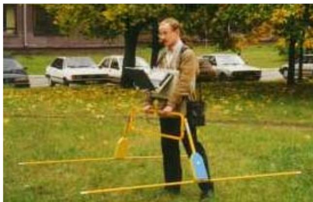
Рис. 6.7. Пример использования «ZOND-12с» с антенной 75 МГц
