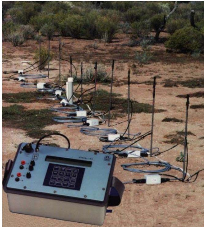
Рис.2.77 Многоканальная система для метода сопротивлений Syscal R2 фирмы IRIS.
