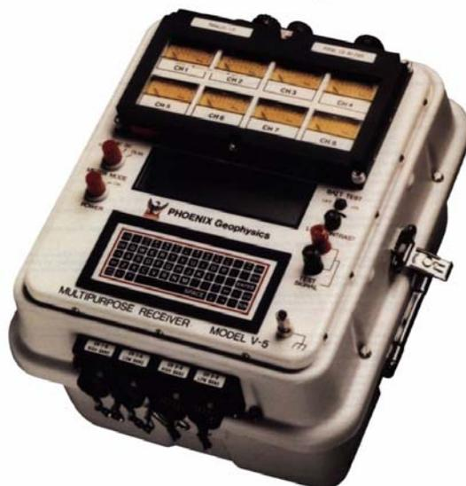
Рис.2.75. Многоцелевой геофизический измеритель V5 ULTRA фирмы PHOENIX. Предназначен для измерения магнитотеллурических и аудиомантителлурических полей, вызванной поляризации, становления поля и метода сопротивлений. В последнем случае число каналов может быть увеличено до 16.
