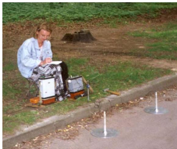
Рис.2.39 Измерение электрического поля на асфальте с помощью активных электродов
