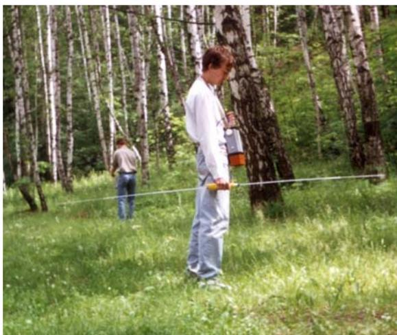
Рис.2.38. Измерение электрического поля с помощью телескопической антенны.
