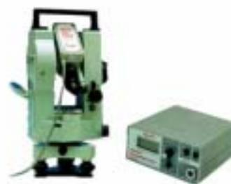
Рис. 8.11. Феррозондовый магнитометр. Магниточувствительный элемент закреплен на зрительной трубе теодолита.
