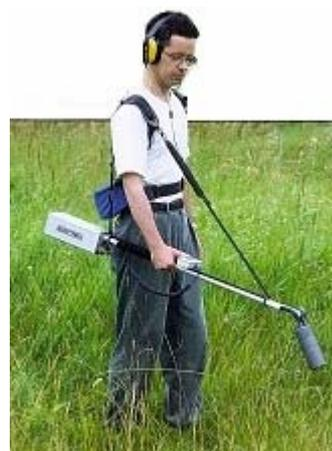
Рис. 8.13 Квантовый магнитометр. Магниточувствительный элемент ориентирован по направлению магнитного поля.
