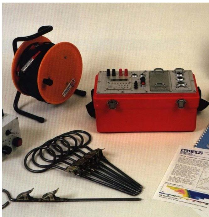
Рис.2.76. Комплект аппаратуры Campus фирмы Scintrex.
