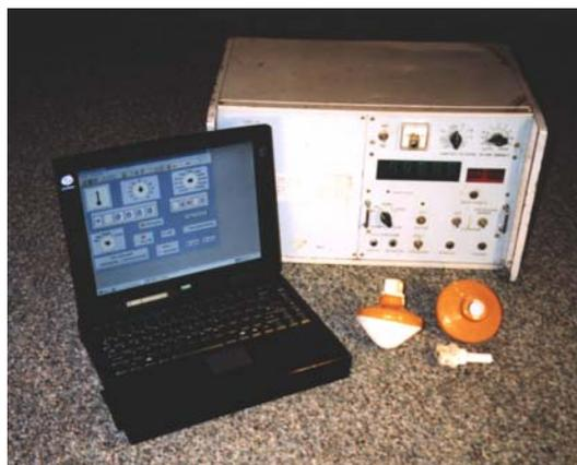
Рис. 4.4. Станция МСВП-8, управляющий компьютер и неполяризуемые электроды.
