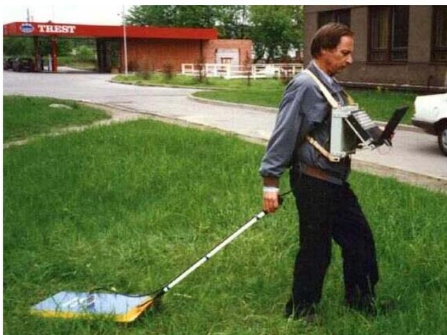
Рис. 6.6. Пример использования «ZOND-12с» с антенной 900 МГц
