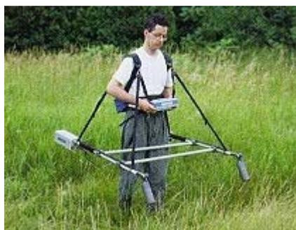
Рис. 8.19. Прибор измеряющий градиент магнитного поля - градиентометр.
