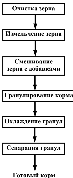
Рис. 2. Технологические схемы приготовления корма из зерна и из необмолоченного зернового вороха
