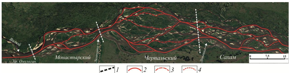
Рисунок 3.23 — Общая схема (космоснимок) разветвленного русла нижней Лены ниже устья Вилы. 1 — границы звеньев разветвлений; 2 — положение стрежневой зоны потока в левом и правом основных рукавах и во вторичных разветвлениях основных рукавов; 3 — то же в субпараллельных рукавах; 4 — то же в диагональных рукавах.
