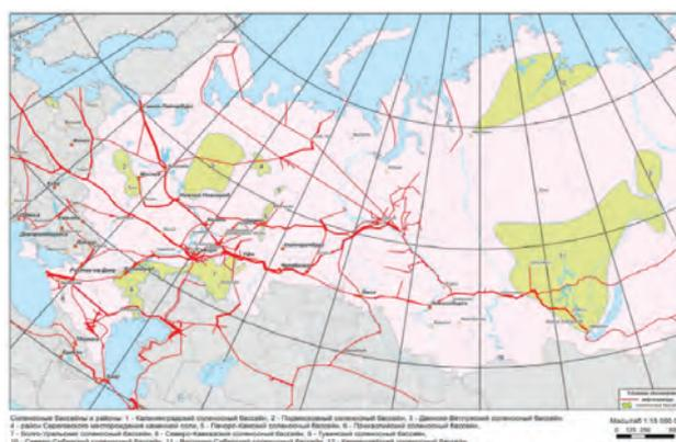
Рис. 8. Схема расположения нефтепроводов и солевых отложений
