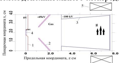
Рис. 1. Плоская ИОС: 1 – резонатор, 2 – извлекающий электрод, 3 – мишень, 4 – выходное отверстие, 5 – подавляющие магниты
