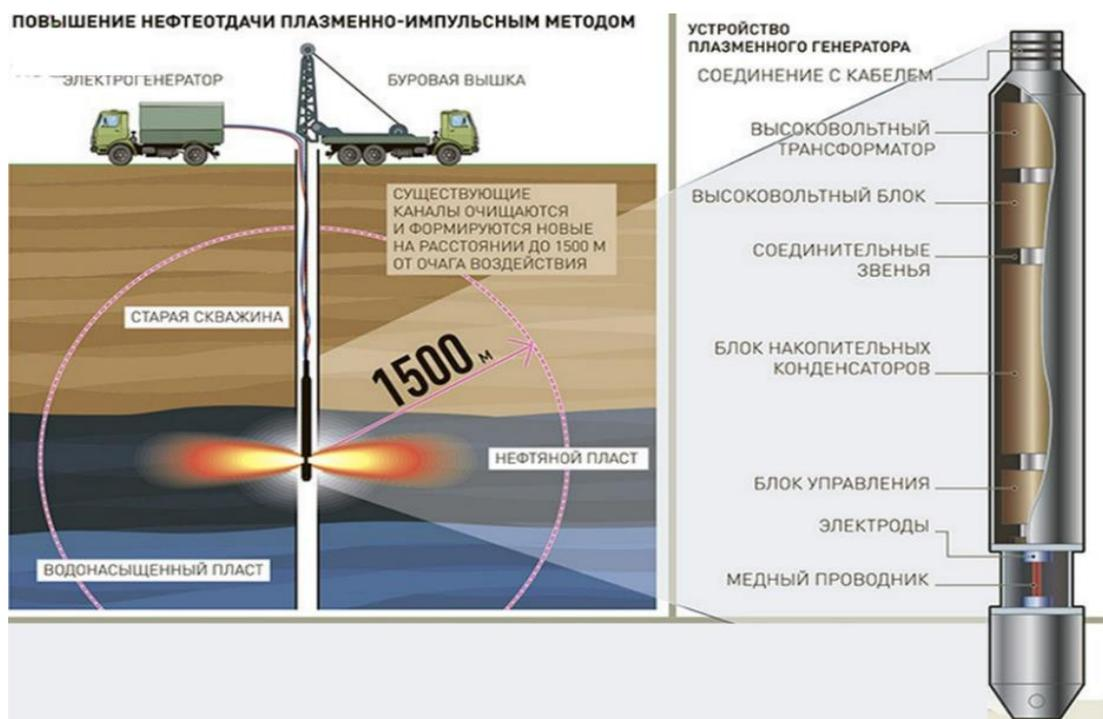
Рис. 2. Конструкция источника колебаний ПИВ
