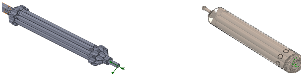
Рис. 2. Вид облучательных устройств. Справа – устройство новой конструкции
