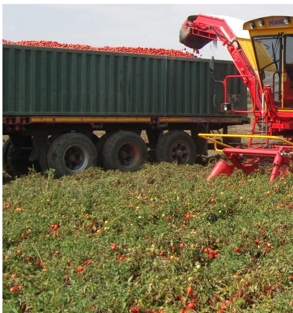
Рисунок 1 – Томатоуборочный комбайн РОМАС М35, собирающий урожай томатов на поле Источник: фотография взята с сайта ООО «АГРОТЕХПРОМ 36». URL: https://agrotechprom.ru/catalog/product/kombayn-dlya-uborki-tomatov.html
