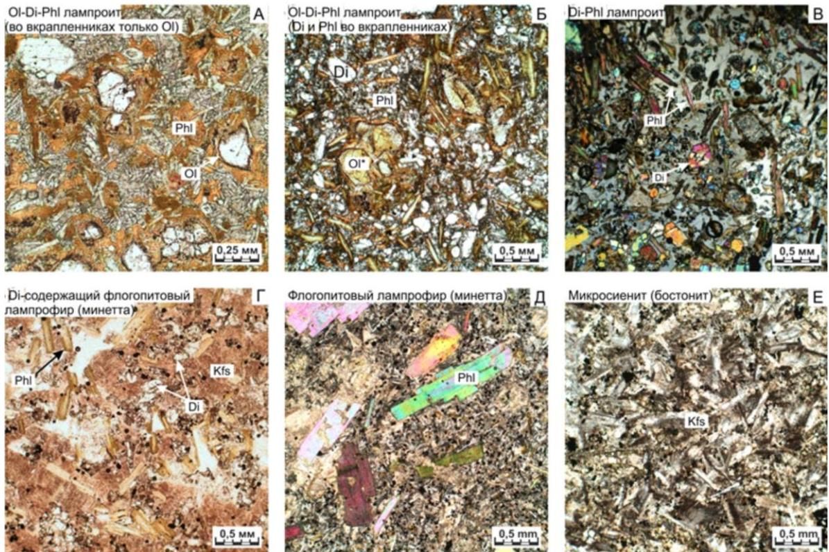
**Рис. 4.** Микрофотографии шлифов пород лампроитовой серии Рябинового массива. А, Б, Г – проходящий свет; В, Д, Е – скрещенные поляризаторы.
