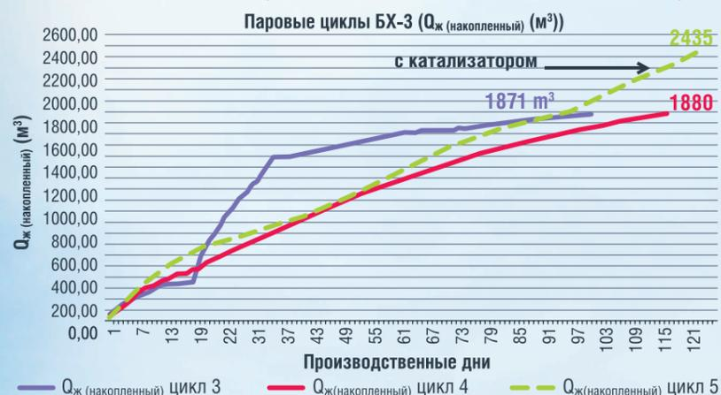
РИСУНОК 3. Накопленный отбор нефти на 3, 4 и 5 циклах, последний с катализатором, где красная кривая Q<sub>н</sub> (накопленный) цикл 5 (виртуальный или расчетный) означает величину добычи, которую скважина должна была достичь в 5-м цикле без катализатора
