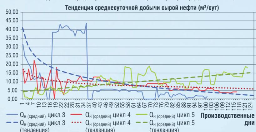
РИСУНОК 6. Динамика среднесуточной добычи жидкости (м³/сут), сырой нефти (м³/сут) и процентного содержания нефти (%) для пятого цикла с катализатором
