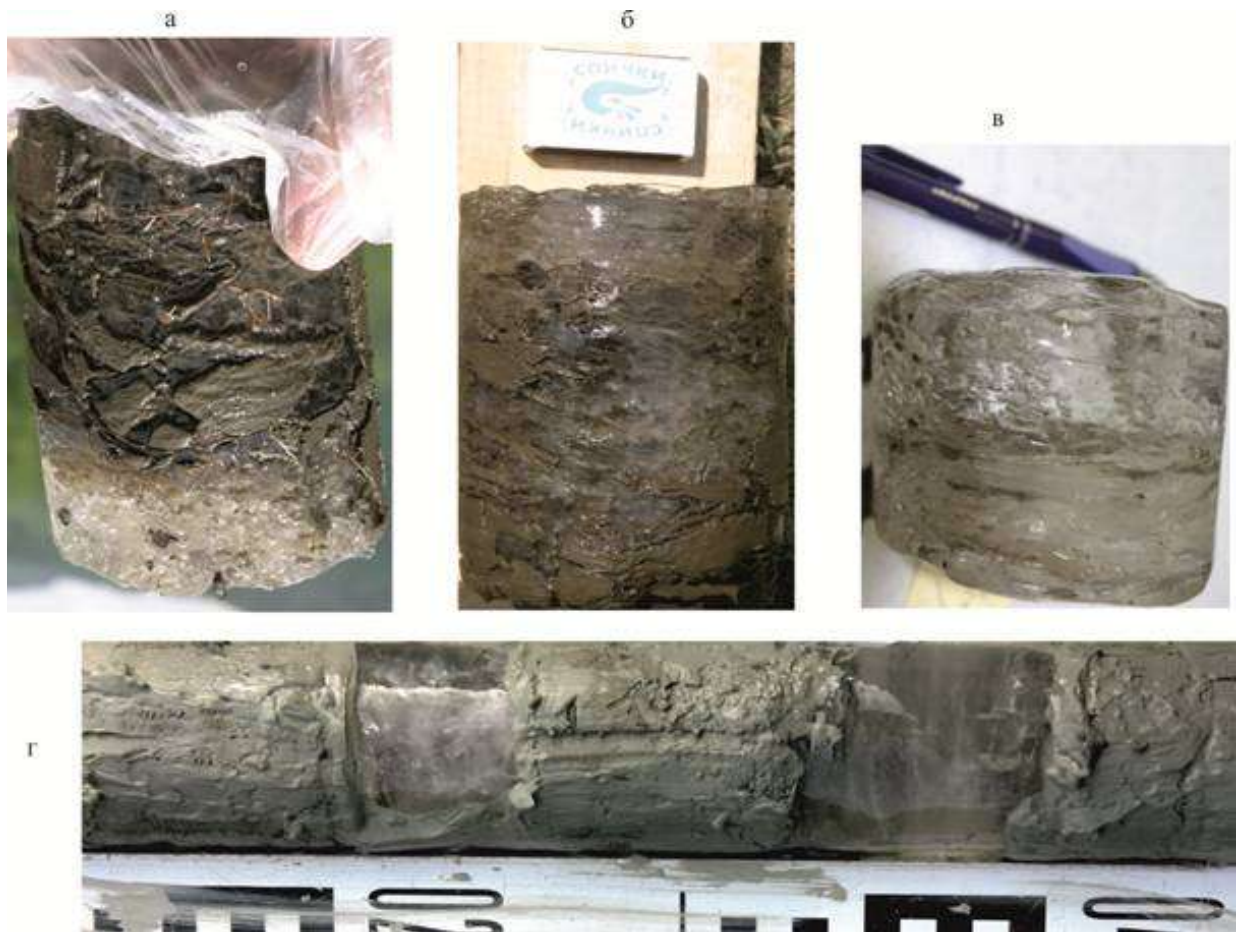
Рис. 7. Типичное криогенное строение бугра пучения Se-14-1
