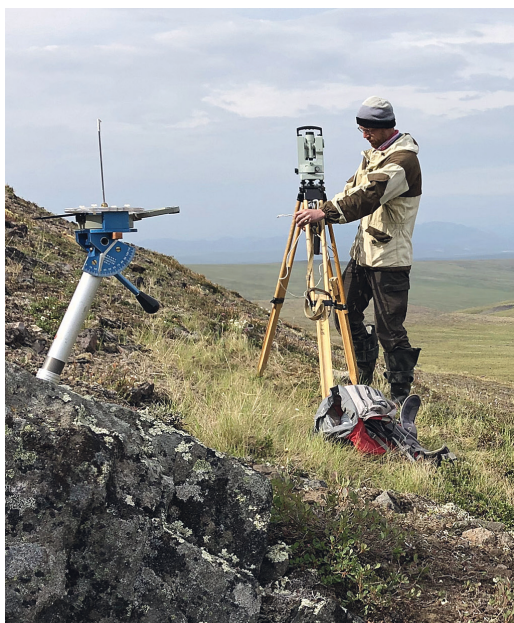
Рис. 3. Слева – фотография теодолита с лазером и стандартного ориентора. Справа – схема отбора керна (образца) при помощи теодолита с лазером и специального ориентирующего устройства (ориентора)
