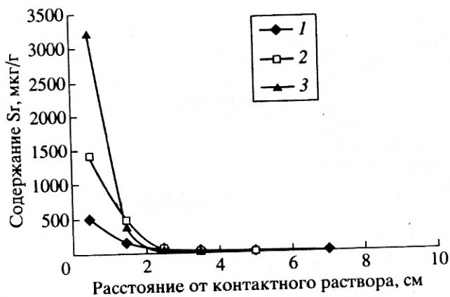
Рис. 3. Распределение ионов стронция по высоте образцов пород различной дисперсности, взаимодействующих с 0.1 N раствором Sr(NO_3)_2 в течение 3 месяцев при температуре -7^\circ C . 1 – песок, 2 – супесь, 3 – суглинок.
