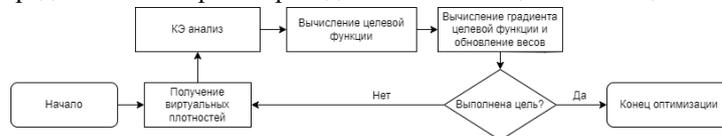
Рисунок 1 – Алгоритм топологической оптимизации с помощью нейронных сетей
