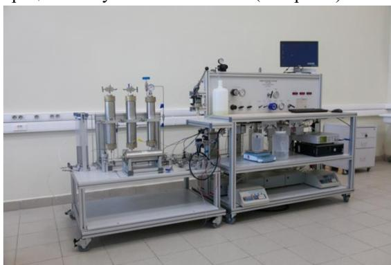
Рис. 1. Фотография фильтрационной установки UFS-200.
