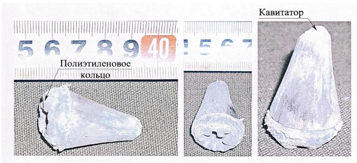
Рисунок - Характерный вид модели из прочной стали после пробития бетонной преграды 300x300x100 (мм<sup>3</sup>)
