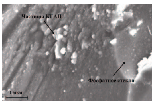
Рис. 5. Микрофотография образца, полученного методом «теплого» прессования.
