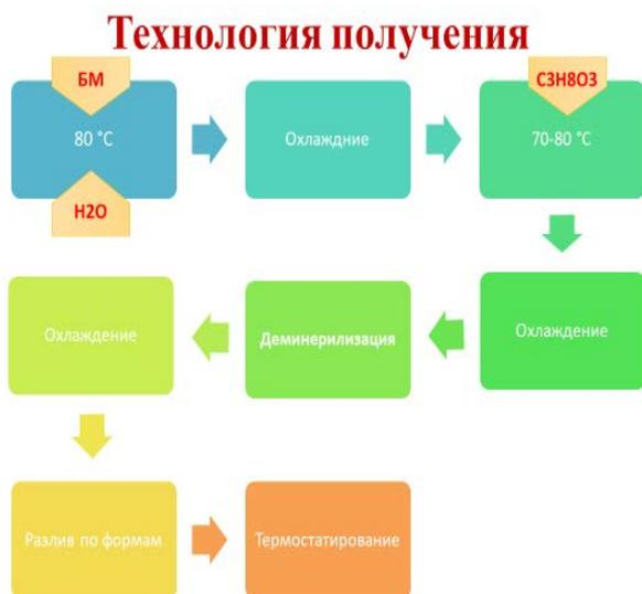
Рисунок 1 - Блок-схема технологии получения биополимеров
