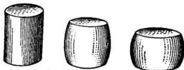
Рис. 1. Бочкообразная форма цилиндрических образцов без торцевых выточек после снятия нагрузки
