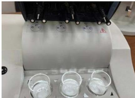
Рис.3. Анализатор TA-Lab с тремя электрохимическими ячейками (НПП «Томьаналит», г. Томск)
