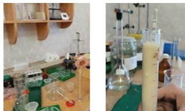
Рис.6. Измерение плотности раствора с ареометром
