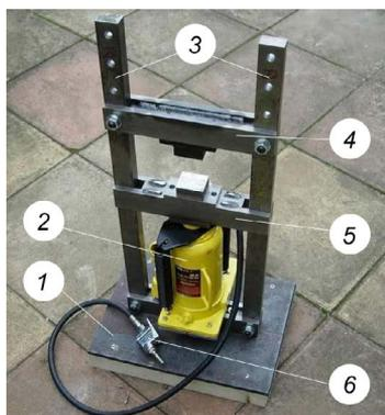
Рис. 3. Домкратный пресс для проведения эксперимента по осадке образцов:
