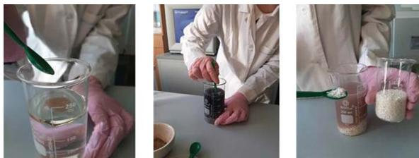
Рис.5. Образование комплекса «йод-хитозан». Снимаем показания прибора по верхнему краю мениска
